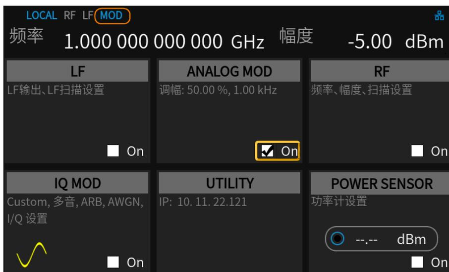
图 8-5 模拟调制总开关
