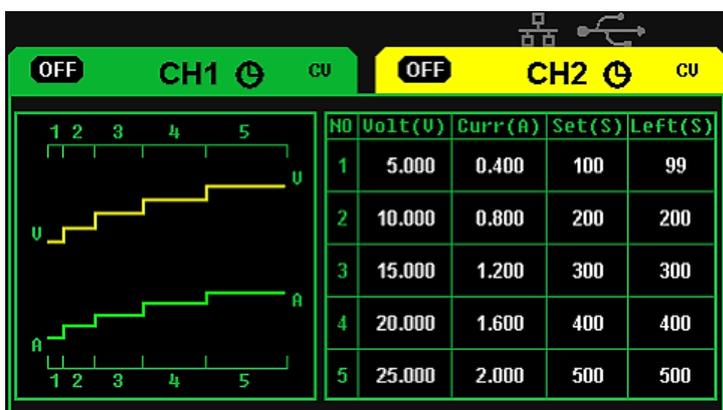
启动定时器之后，若按下通道开关“on/off”键关闭通道输出，则计时停止。
