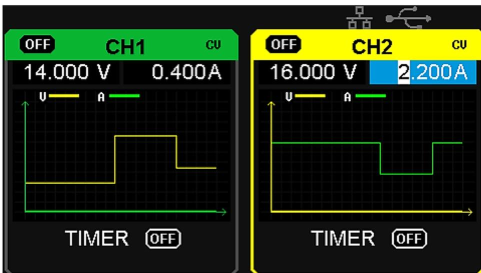
**说明：**黄色线表示电压输出曲线，绿色线表示电流输出曲线，曲线纵轴表示输出值的大小（0~32V/0~3.2A）。
