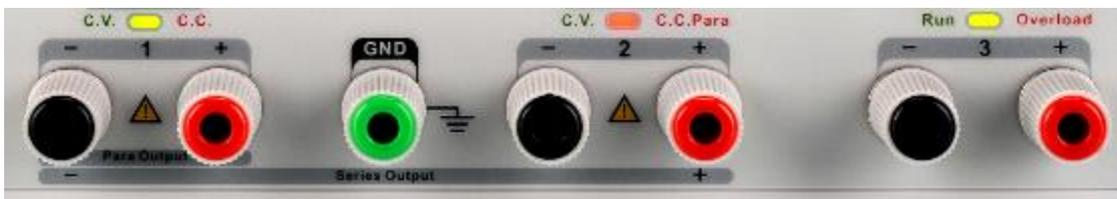
前面板上，有通道 1、通道 2、通道 3 的  $\pm$  连接端，以及通道 1 和通道 2 的公共接地端，各自有明显的丝印标识。具体使用连线方法，参见后续“控制面板操作”说明。
