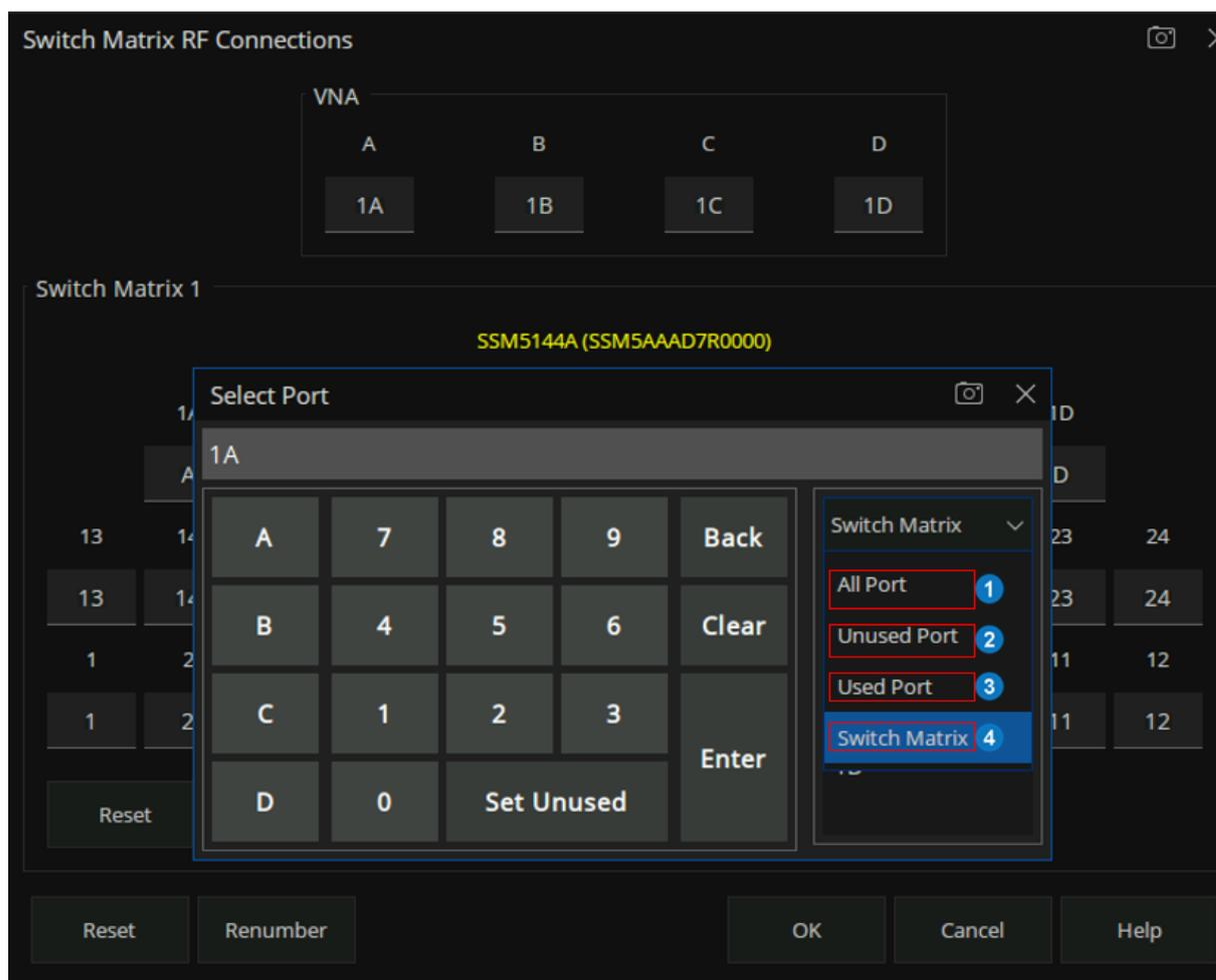
① **All Port**: 表示所有的射频端口号（包括 VNA 射频端口和 SSM 射频端口），用户在其显示的下拉列表中自定义选择某一端口；
