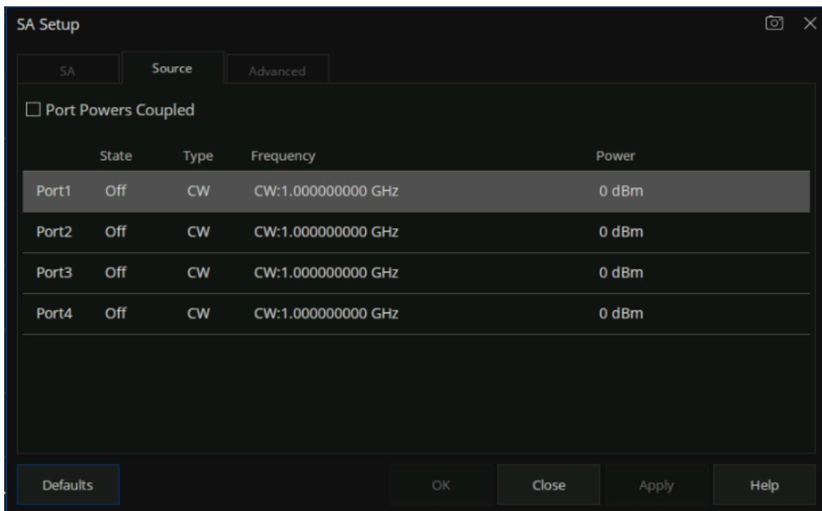
图 11-11-7 SA Setup 的 Source 选项卡界面
