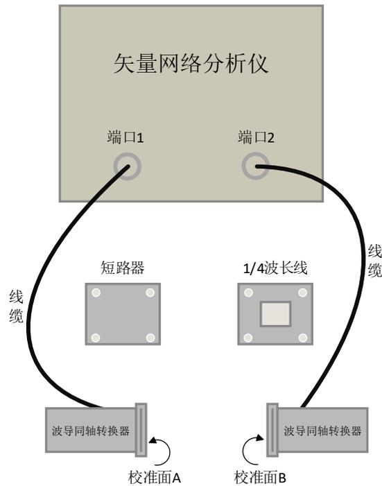
图 15-11 波导校准连接示意图
