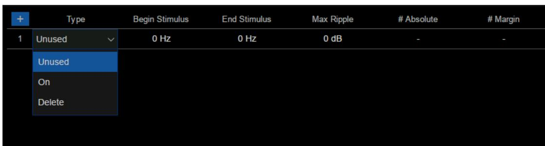
图 8-11 纹波极限线设置界面
