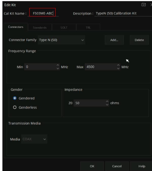
图 7-23 编辑新导入校准件示意图
