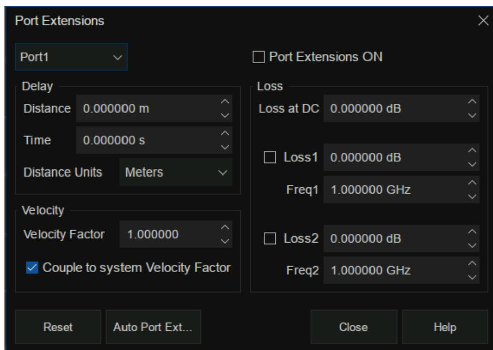
图 7-5 端口延伸设置界面
