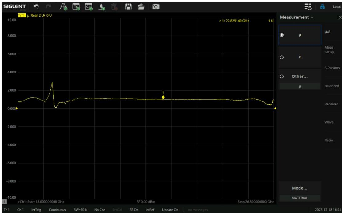
图 15-16 磁导率测量结果 (PEI 材料)
