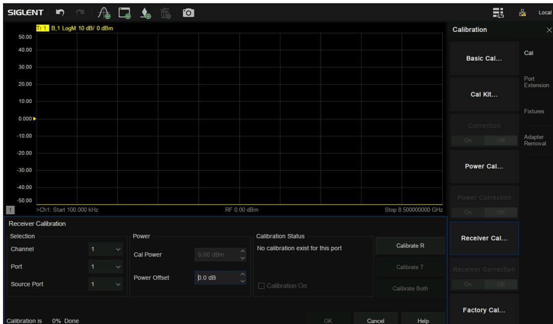
图 7-4 接收机校准设置界面
