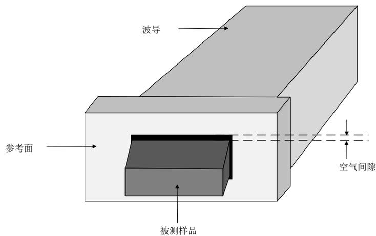
图 15-13 样品安装示意图
