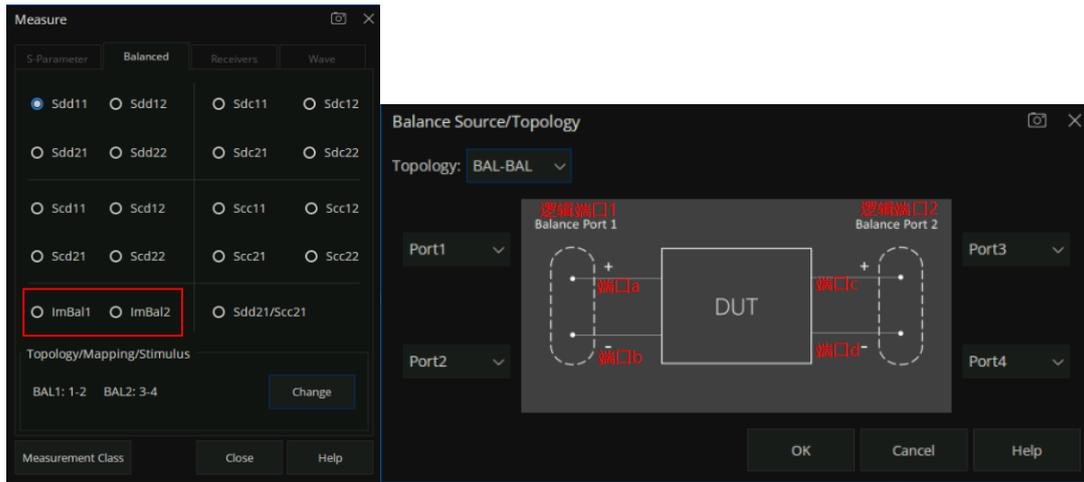
(3) 测量单端-单端-平衡设备时的 IMBal1 至 IMBal4 参数。
