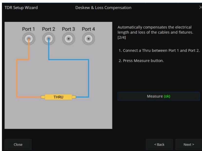
图 10-10-5 TDR 延时损耗补偿校准向导
