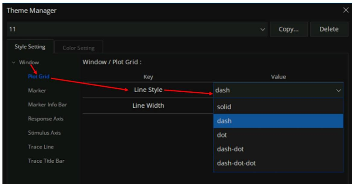
图 5-19 视图网格菜单设置网格线样式
