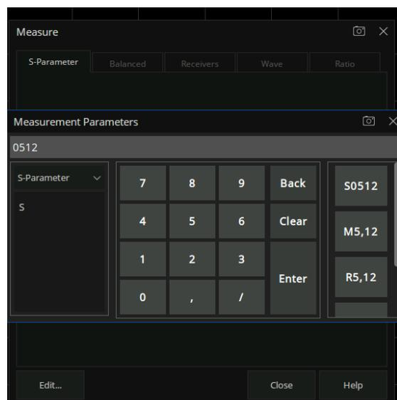
通过编辑框直接输入 S 参数
