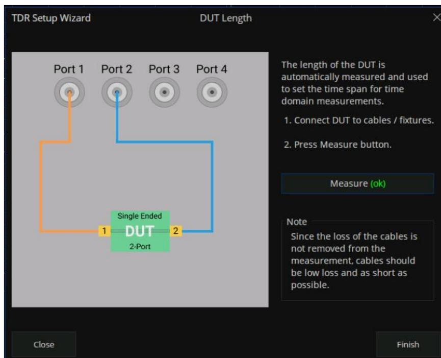
图 10-10-7 DUT 长度测量向导
