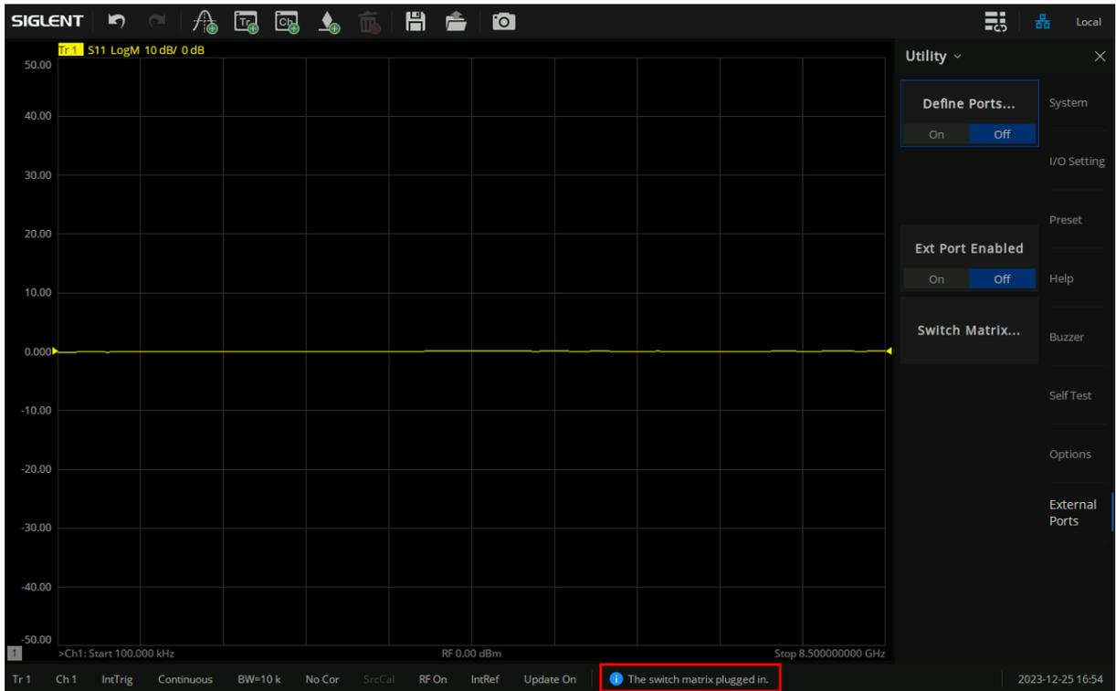
2. 通过前面板按键，按 **System** > “External Ports” > “Ext Port Enabled”，选择 On，此时 UI 右上角将会显示矩阵开关标识符 “
