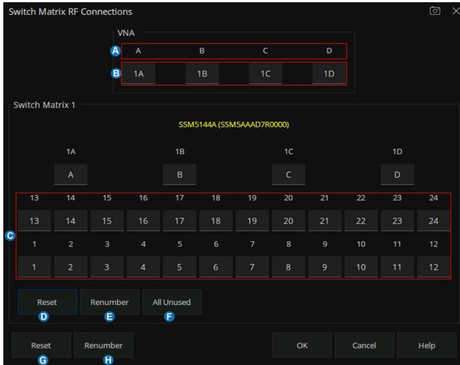
**A**：VNA 选框的 A/B/C/D 标签表示矢量网络分析仪端口的四个物理端口。
