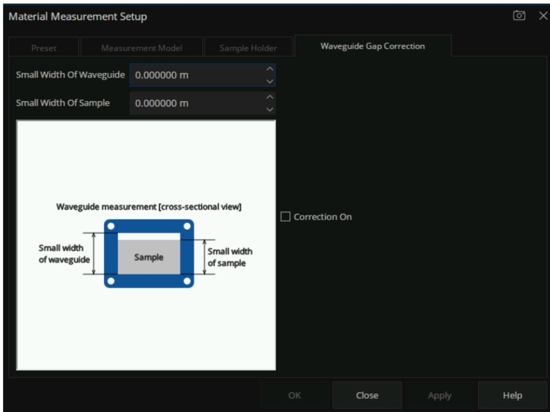
图 15-8 Waveguide Gap Correction 选项卡
