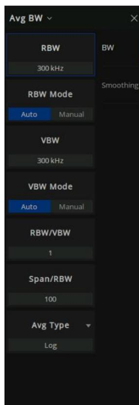
图 11-11-5 频谱分析信号处理相关参数设置
