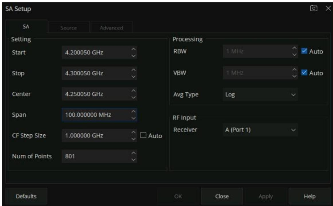
图 11-11-3 SA Setup 的 SA 选项卡设置界面
