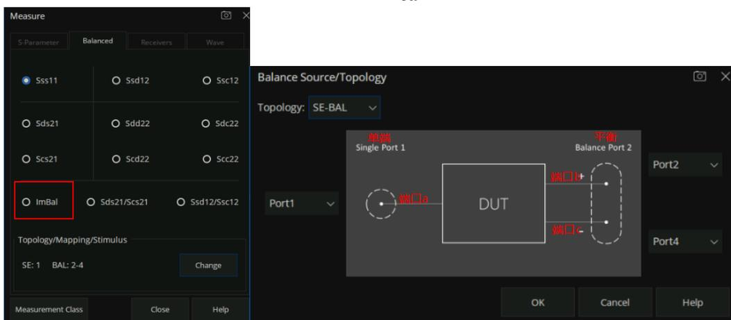
(2) 测量平衡-平衡设备时的 ImBal1 和 ImBal2 参数。
