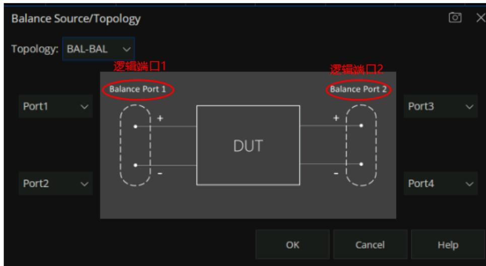
“逻辑端口”用于描述已重新映射到新端口号的物理矢量网络分析仪的测试端口：
