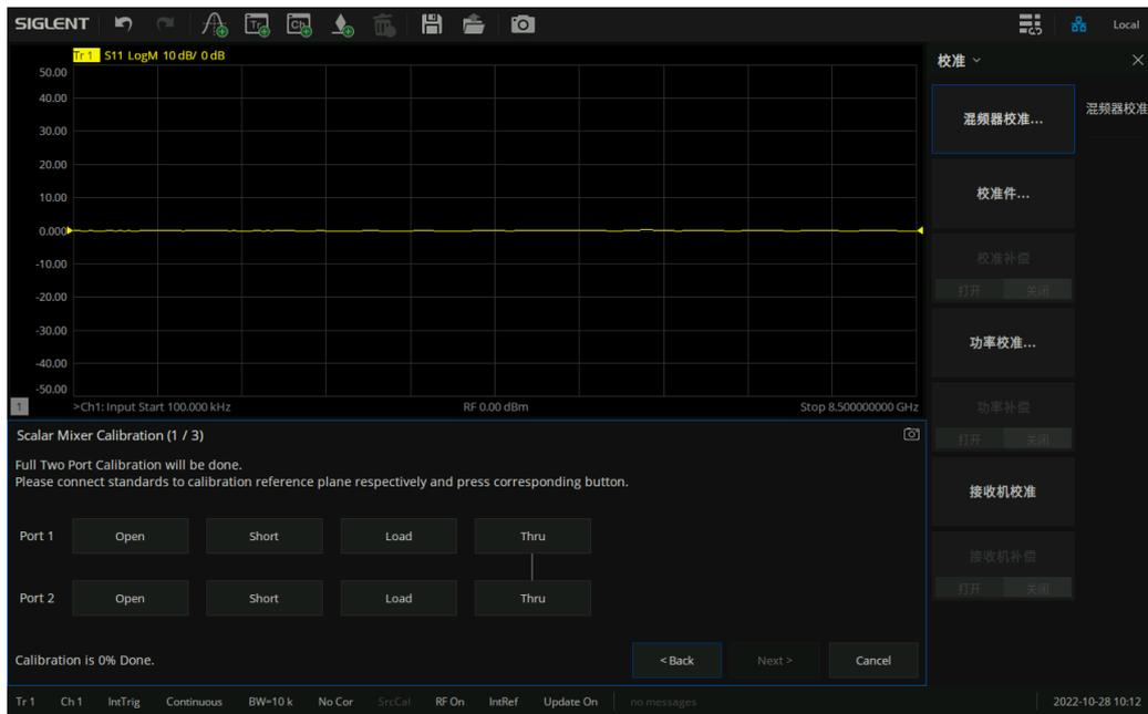
图 13-8 混频器校准界面
