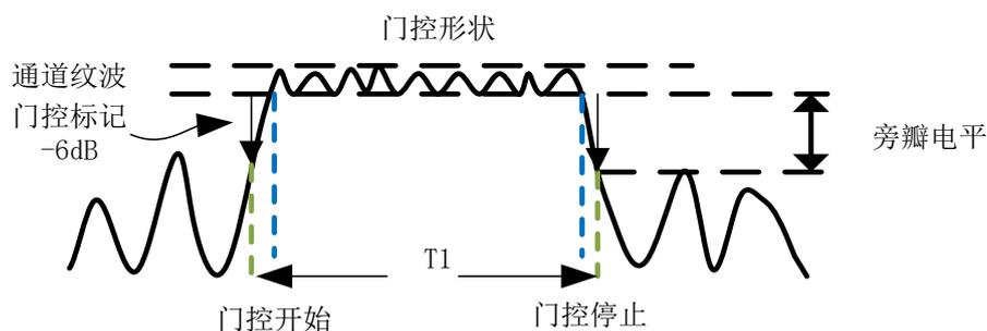
图 8-15 门控示意图
