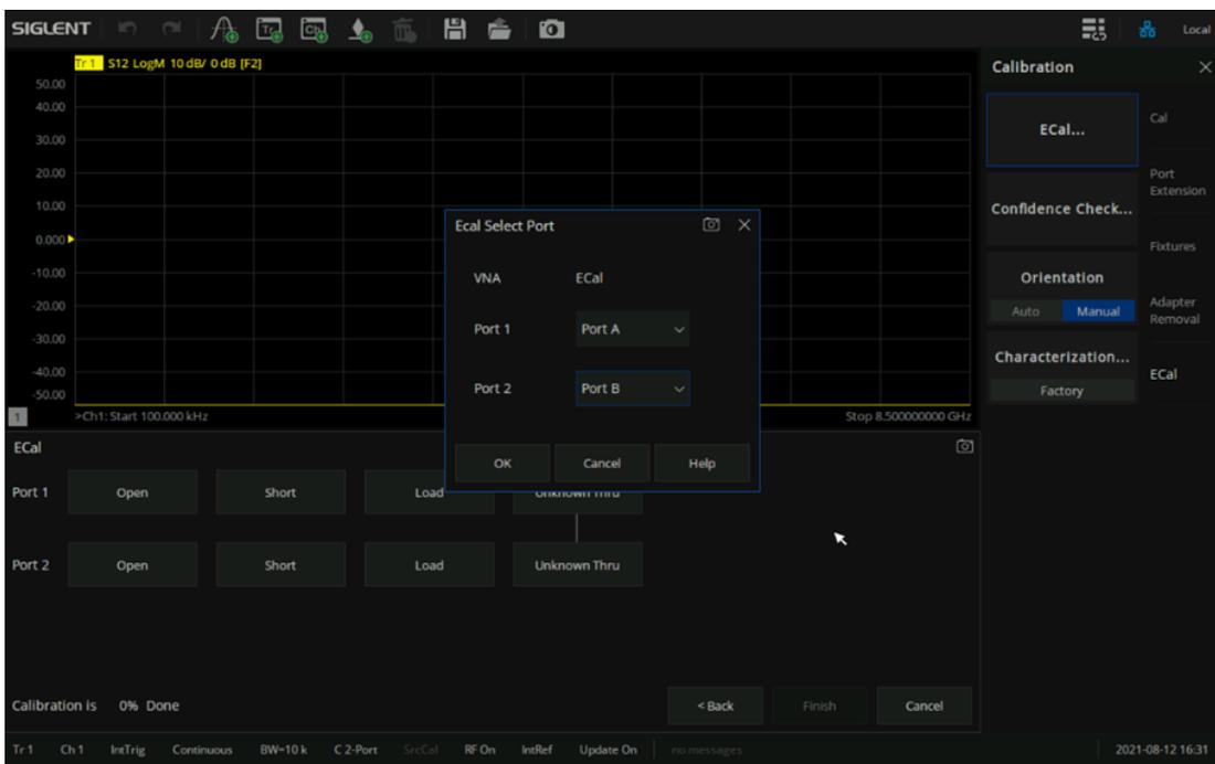
图 7-18 手动定位端口示意图
