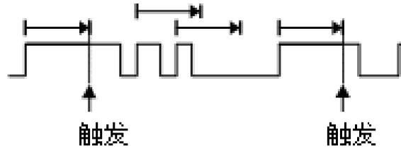
可以在触发设置对话框中设置触发源和斜率（上升沿、下降沿）、超时类型（状态、边沿）和时间。在超时触发中也可设置触发释抑、耦合以及噪声抑制，具体设置方法，请分别参见“触发释抑 (Holdoff)”、“触发耦合”和“噪声抑制”章节。
