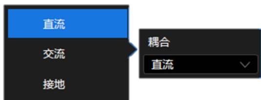
**菜单列表** -- 用于在多个可选参数间切换，如通道的耦合方式。方法：点击参数区域弹出参数的列表，然后在列表中选择需要的参数。
