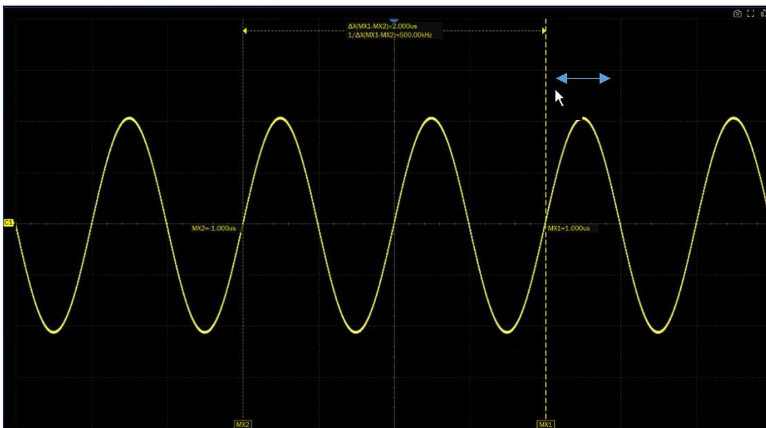
也可以在跟随样式下点击 $\Delta X$ 或 $\Delta Y$ （设置参考光标后）显示区域后拖动该区域，实现多根光标的同时移动，如下图。
