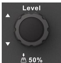
所有的前面板旋钮都有多种操作模式：旋转模式表示一种功能，按下模式则表示另外一种功能。旋钮周围的标识表示旋钮的功能。
