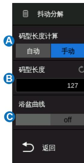
抖动分解出来的结果在“测量”中体现，可以在测量菜单中添加想要观察的抖动分量，包括测量值、直方图分布、时域轨迹图、频谱图等，详见“测量”小节。
