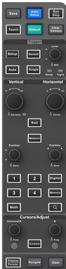
SDS7000A 系列示波器的前面板设计成不必打开软件菜单，即可操作基本示波器功能。使用 Horizontal 和 Vertical 控制功能的方式与其它示波器相同。下面介绍了各种控制功能。
