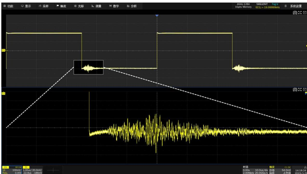
主窗口中未被灰色背景覆盖的区域即为放大的区域。在主窗口被选中时，可通过旋转水平档位旋钮改变主时基，通过旋转垂直档位旋钮改变主波形的垂直档位；旋转水平 **Position** 旋钮和垂直 **Position** 旋钮在水平和垂直方向移动主波形。在主窗口的某个点上双击可快速将此点的位置设置为 Zoom 窗口的中心点。
