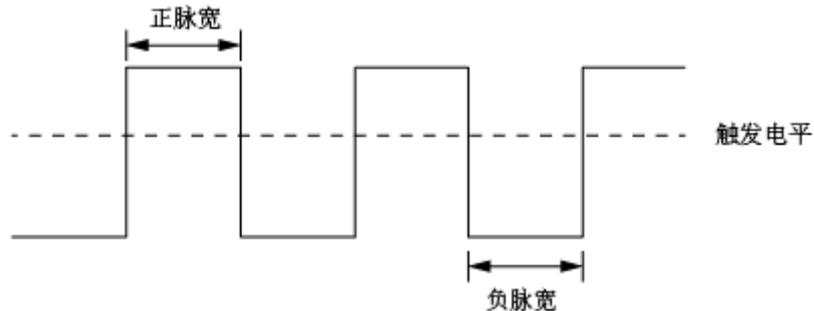
**小于时间值 ( $\leq$ )** -- 选定“ $\leq$ ”后，点击 **上限值** 设置时间。假定设置时间为 100 ns，若脉宽时间  $t \leq 100\text{ns}$ ，则波形在脉宽结束处触发。否则，波形不触发。
