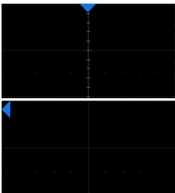
**触发延迟指示符** 三角形，位于网格的水平方向。触发延迟在水平方向上确定示波器轨迹在显示屏上的位置，从而可以观察触发时间以前的信号。当触发位置在屏幕外时，三角形的方向变化为指向屏幕外。
