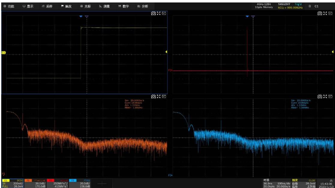
此例使用了两种嵌套运算的方式，来实现对 C1 波形的微分运算结果的 FFT 分析:
