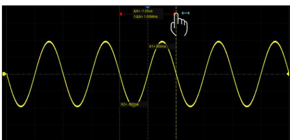
将手指放到光标位置后单点移动控制光标的位置
