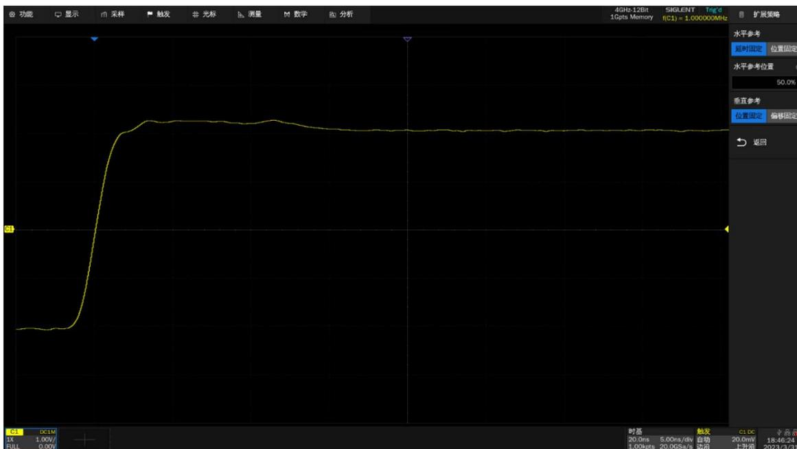
延时固定，水平档位设置为 5ns/div，水平延时绝对值 (20ns) 保持不变，延时的格数变化为 -4 div
