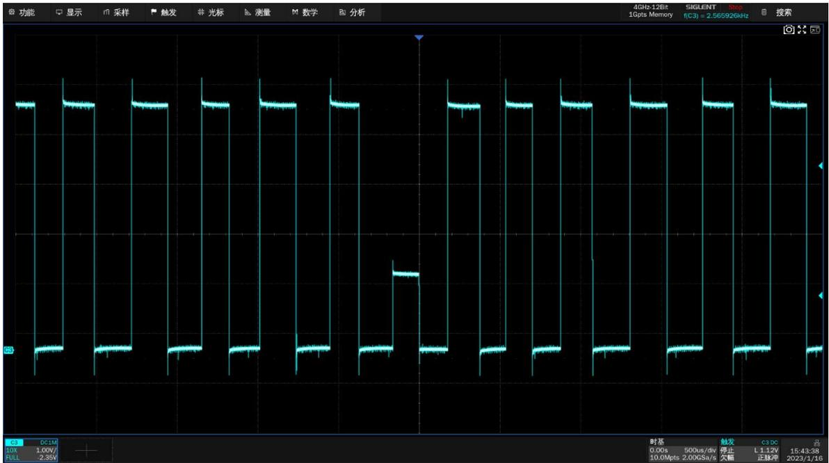
第二步开启搜索功能，并在搜索对话框执行从 **触发复制**，使示波器按和触发条件相同的设置搜索矮脉冲。将水平档位调整到 100ms/div，可以看到每隔 200ms 就会有一个搜索标记，全屏 1s 的时间范围内共发现 5 个矮脉冲：
