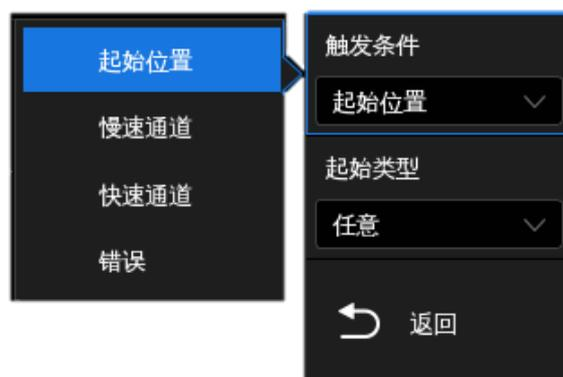
**起始位置** -- 示波器将在消息开始时触发（56 个同步时钟后）。您可以选择消息类型：快速通道消息、慢速通道消息或任意。
