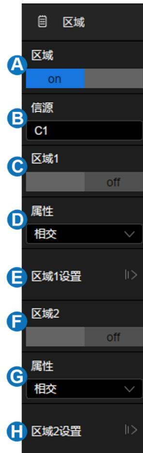
区域可以直接通过鼠标拖拽绘制矩形框，或通过 **区域设置** 下的对话框实现选择和移动。区域颜色与所选的信源通道颜色相同。
