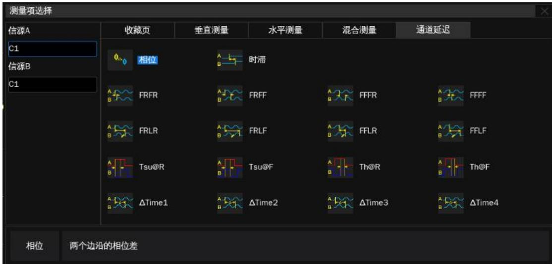
在参数选择区域内，先指定 **信源 A** 对应的通道，再指定 **信源 B** 对应的通道，最后选择参数。例如要激活 C1 和 C2 之间的时滞测量，可按下述步骤操作：
