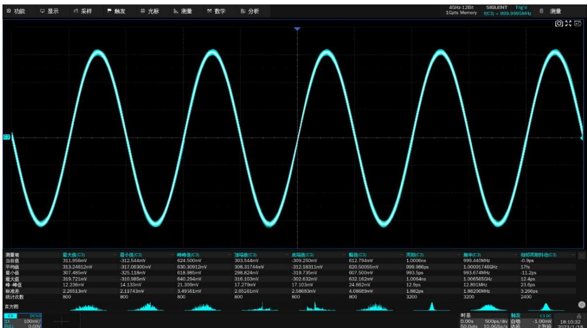
M2 模式下，一次显示最多 12 个参数测量，用户可在 **显示测量项总数** 中修改上限值。开启测量统计，统计信息按列分布在测量项右侧。点击固定行进行添加、替换测量项。M2 模式下无法显示直方图的缩略图。
