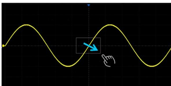
通过单点拖动手指绘制矩形框，手指移开屏幕出现菜单，可选择区域触发、直方图功能。在手势开始时请保持角度在  $45^\circ$  左右以保证仪器能正确识别为画框操作
