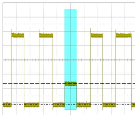
首先进行触发的设置令波形在矮脉冲处触发，触发类型为欠幅触发。关于欠幅触发的设置详见“欠幅触发”一节。
