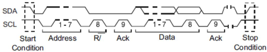
**重启条件** -- 当另一个启动条件在停止条件之前出现时示波器触发。
