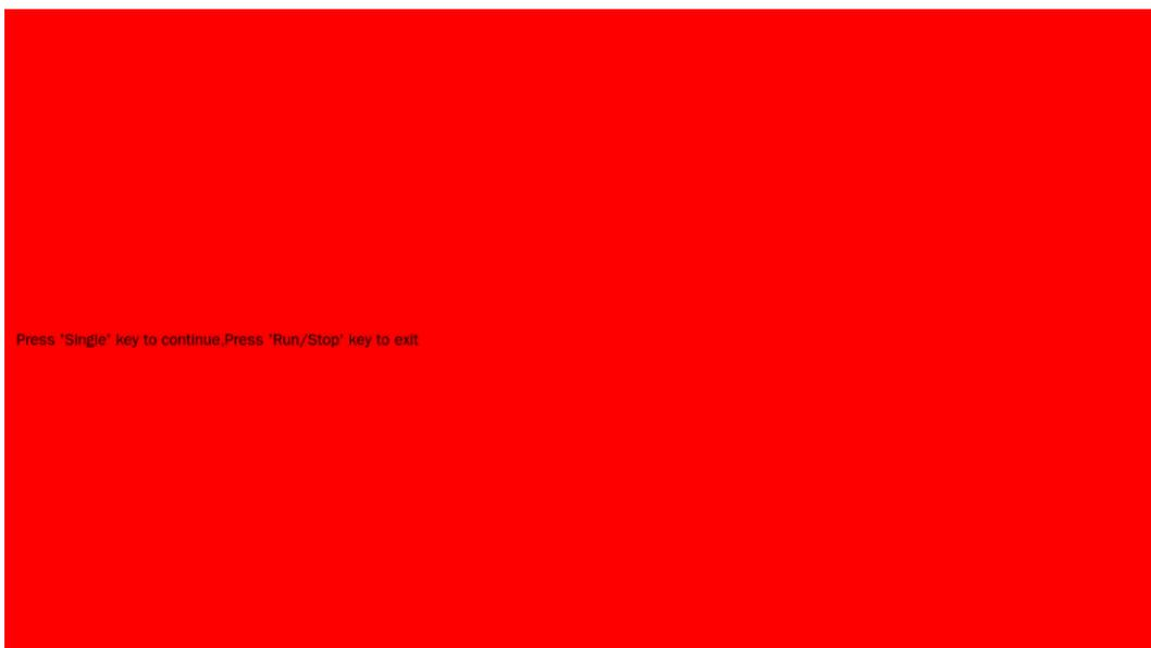
如上图，按屏幕提示信息连续按 **Single** 键切换至绿色、蓝色屏幕显示模式。在每种颜色对应界面下观察屏幕是否存在严重色差、污点或刮伤等问题。
