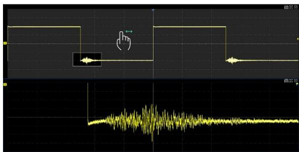
在主窗口的灰色区域左右拖动鼠标来控制波形的水平位移；上下拖动鼠标来控制波形的垂直位移
