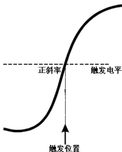
在一些特殊的触发类型下，系统会自动设置好触发电平，此时不需要用户来设置，如采用 AC Line 作为触发源的边沿触发。
