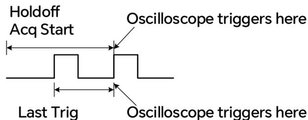
**采集开始 (Acq Start)** -- 开始计算触发释抑的位置为第一个满足触发条件的时间点，与上次的触发位置无关。以上图为例，每次触发释抑都需等到采集脉冲序列的第一个上升沿后开始计算，触发间隔始终大于一个脉冲周期。
