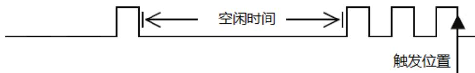
可以在触发设置对话框中设置触发源和斜率（上升沿、下降沿）、空闲时间和边沿数。注意指定的空闲时间应大于脉冲周期，这样才能保证在指定编号的脉冲上触发。
