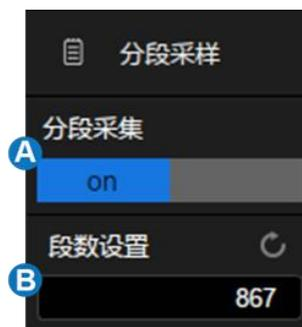
Sequence 模式是一种快速采集模式，它将示波器的存储深度分成若干（最多 124,000）等份，每个等份里只存储触发到的单次波形。在存储的段数没有达到设置的段数之前，示波器只进行采集和存储，而不进行显示和数据处理。这种模式可以最小化触发事件之间的死区时间，因而极大地提高刷新率。本设备在 Sequence 模式下可以达到最低 0.9 us 的触发间隔，对应 1,100,000 帧/秒的波形刷新率。
