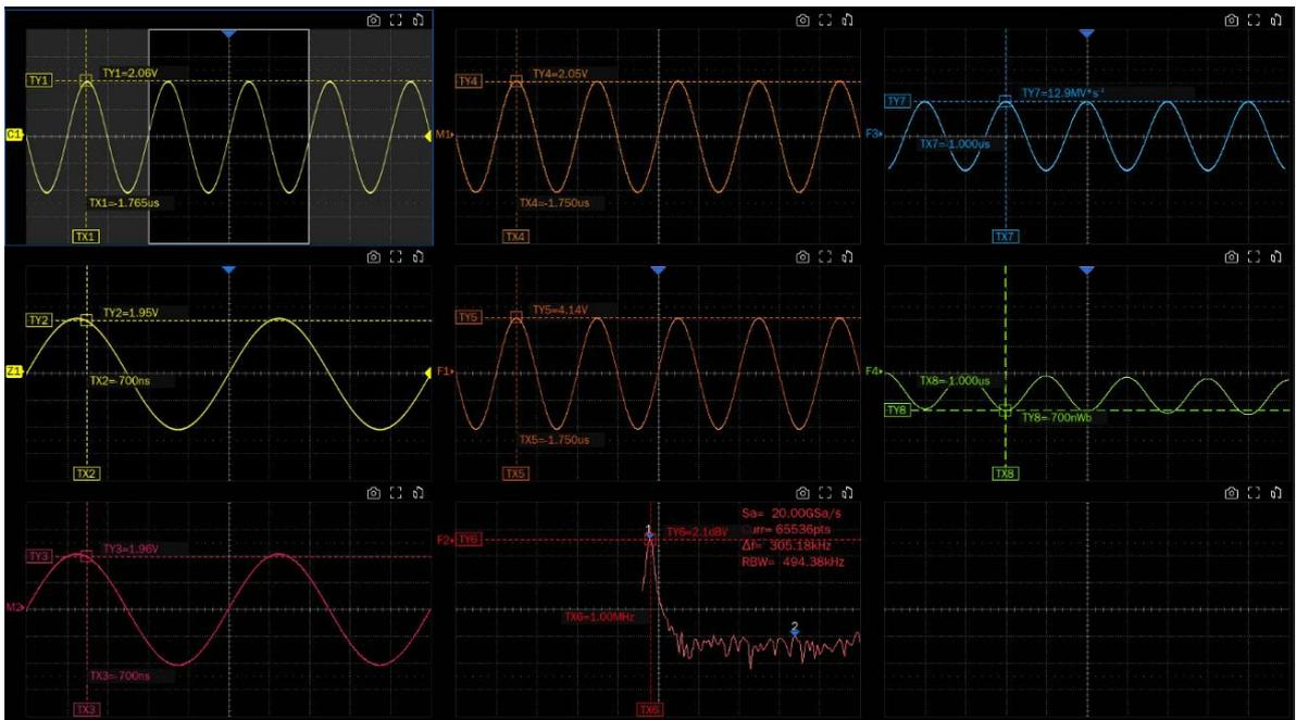
测量 -- 根据选择的测量项来标示计算测量项所对应的坐标，测量光标不可调节。此模式有 4 组光标 MEA1~MEA4
