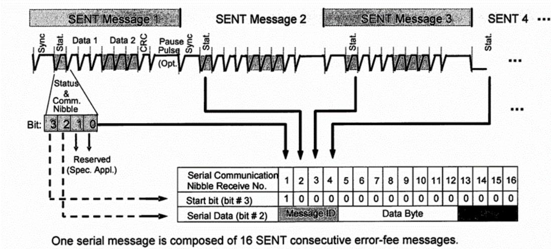
串行消息帧包含 21 位有效数据。可根据配置位（串行数据第 3 位，串行通信第 8 个半字节）选择两种不同的配置：
