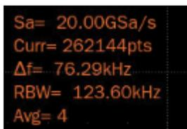
Sa -- FFT 采样率，FFT 运算结果将呈现第一奈奎斯特域 (DC~Sa/2) 的频谱。注意 FFT 采样率可能和时域的采样率不一致。假设最大点设置为 2 Mpts：
