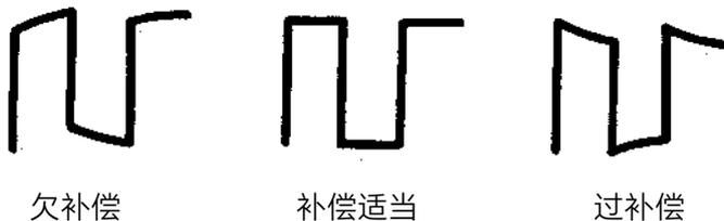
5. 用非金属质地的“一”字型螺丝刀调整探头上的低频补偿调节孔，直到显示的波形如上图“补偿适当”。
