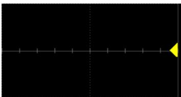
**触发电平指示符** 三角形，位于网格右侧的垂直方向，其颜色与示波器目前设置触发的通道颜色相同。
