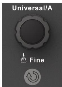
当参数设置区变成高亮时都可以使用光标控制区的多功能旋钮/旋钮 A 来修改数据。按下旋钮起选择的作用。默认功能为调节波形亮度。在光标菜单激活时，该旋钮作为专用光标调节旋钮 A 使用。
