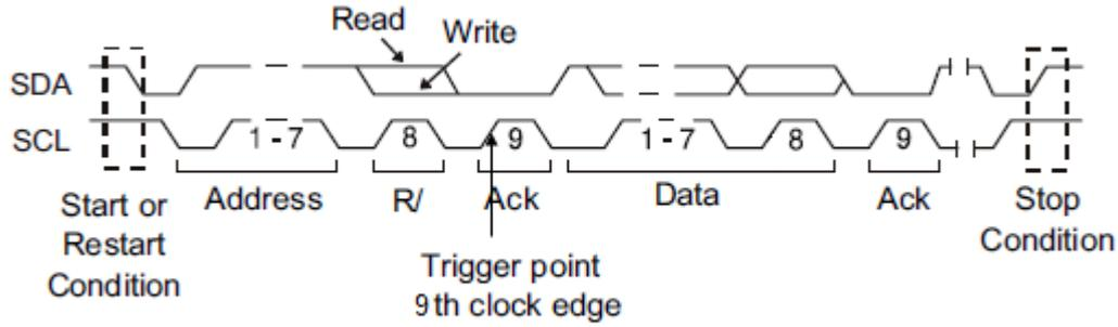
帧 (开始: 7bit 地址: 读/写: 应答: 数据: 应答: 数据 2) -- 如果码型中的所有位都匹配, 则在紧随数据 2 的应答位上触发。
