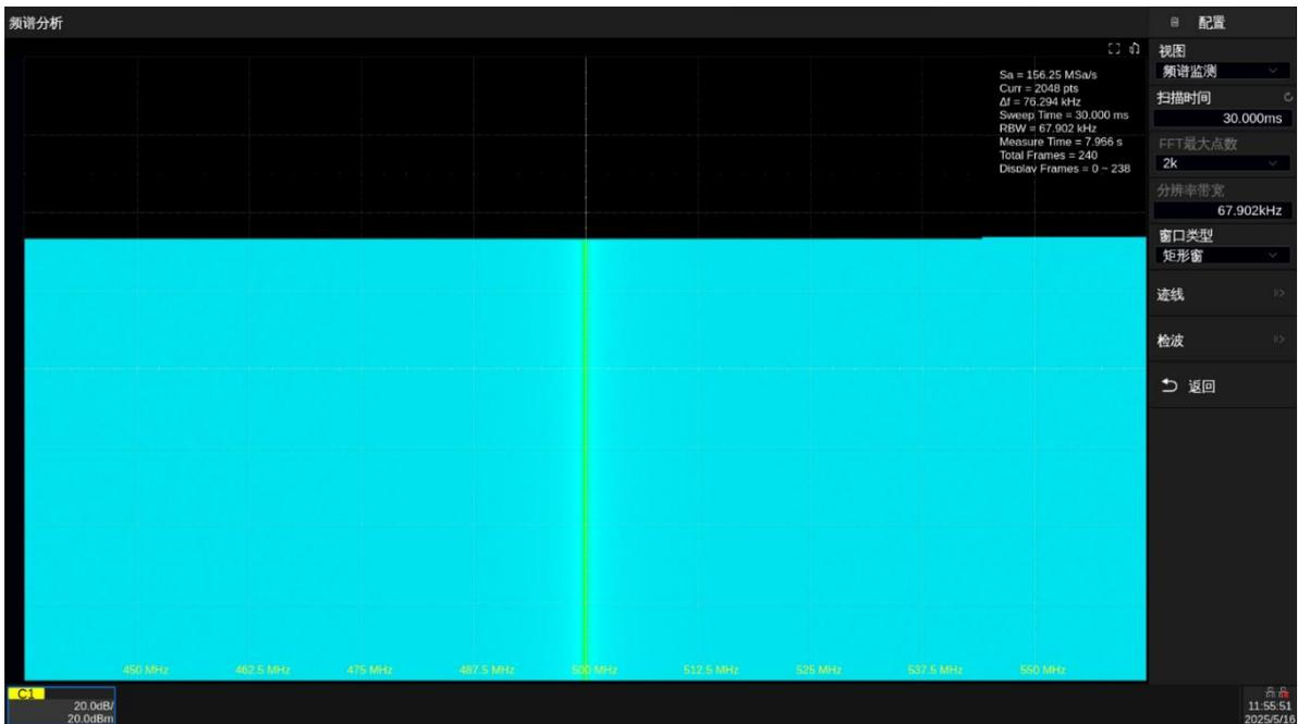
频谱检测图纵向高度可同时展示最多 340 条波形数据，最大记录 50000 帧数据，当已生成波形总帧数大于 50000 帧时，超过 50000 帧的历史数据将会被丢弃。
