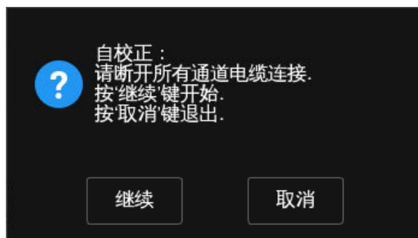
3. 自校正开始后，屏幕会出现进度条以显示自校正进度。该过程中，操作示波器不会有响应，直至自校正结束。校正完成后，点击屏幕或按任意键退出。
