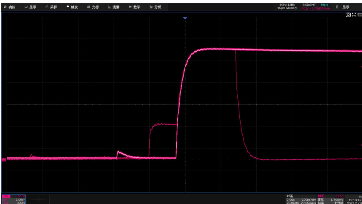
此时使用区域触发可以高效地隔离出感兴趣的事件，且操作非常简单：打开区域触发，设置区域与总线冲突部分的波形相交，如下图：
