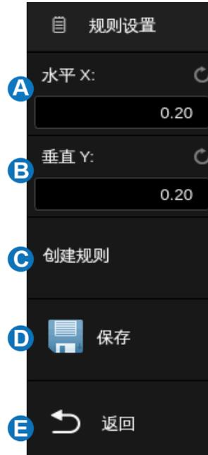
模板测试下，用户通过对要检测信号创建特定规则（包括设置信号的水平调整范围和垂直调整范围），然后观测信号是否超出规则范围来检测信号变化。
