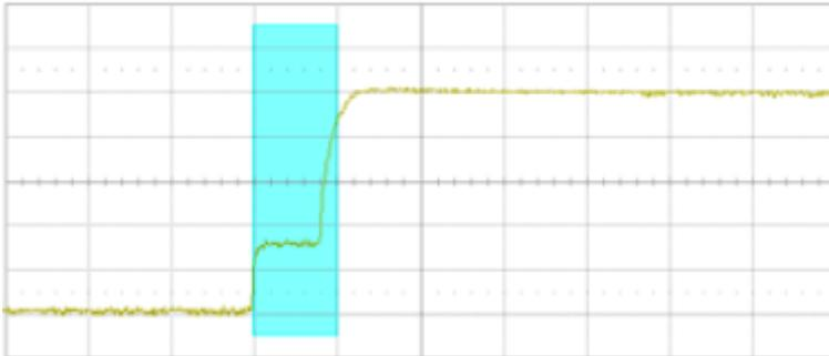
通过常规的边沿触发无法精确地捕捉到该波形，仅仅可以利用本设备的高刷新率，通过打开余辉的方式来确认有总线冲突的情况发生：
