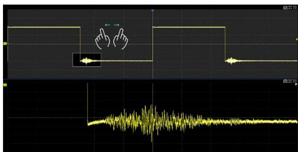
在主窗口的灰色区域通过水平方向的两点缩放手势控制主窗口的水平档位；通过垂直方向的两点缩放手势控制主窗口的垂直档位
