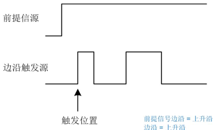
点击 **前提信号设置** 区域设置前提信号源和阈值；点击 **边沿触发设置** 区域设置边沿触发源、阈值和斜率。
