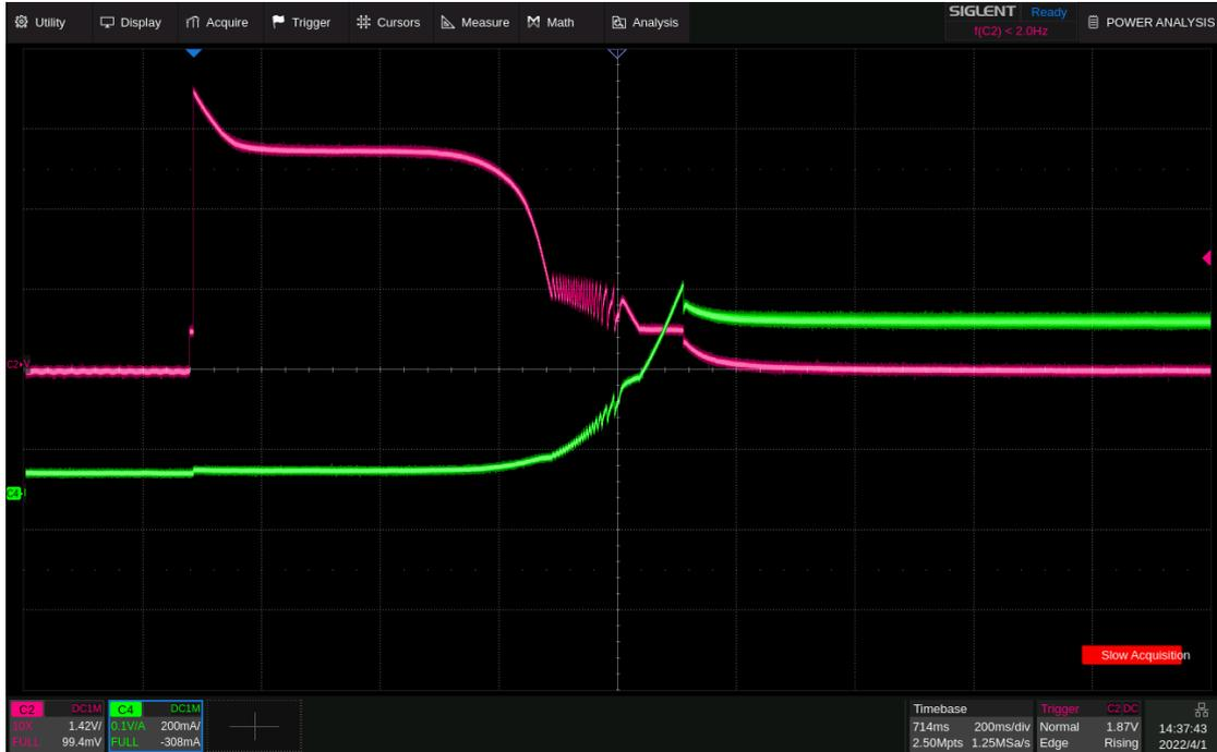
上电时 MOSFET 上的电压和电流波形
