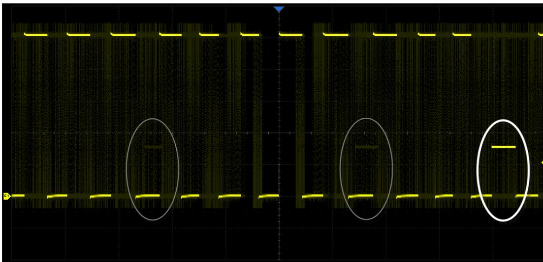
在显示对话框和余辉关闭的情况下，执行 **显示** > **余辉** 可快捷打开无限余辉功能。
