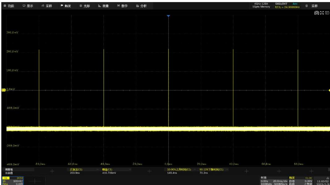
普通模式，在 100Mpts 存储深度下能以 500MSa/s 的采样精度在屏幕上获得 5 个脉冲
