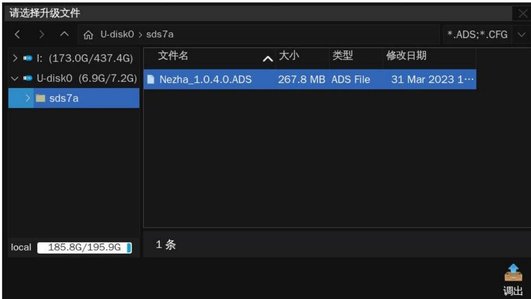
在升级对话框中点击或点击 **升级**，即开始升级操作。示波器首先会将升级文件 (\*.ads) 拷贝到本机并解析，如果解析成功，将出现以下界面。用户可选择 **取消** 退出升级，或选择 **重启** 立即重启示波器并执行升级操作，或等待示波器倒计时完毕自动重启示波器并执行升级操作。
