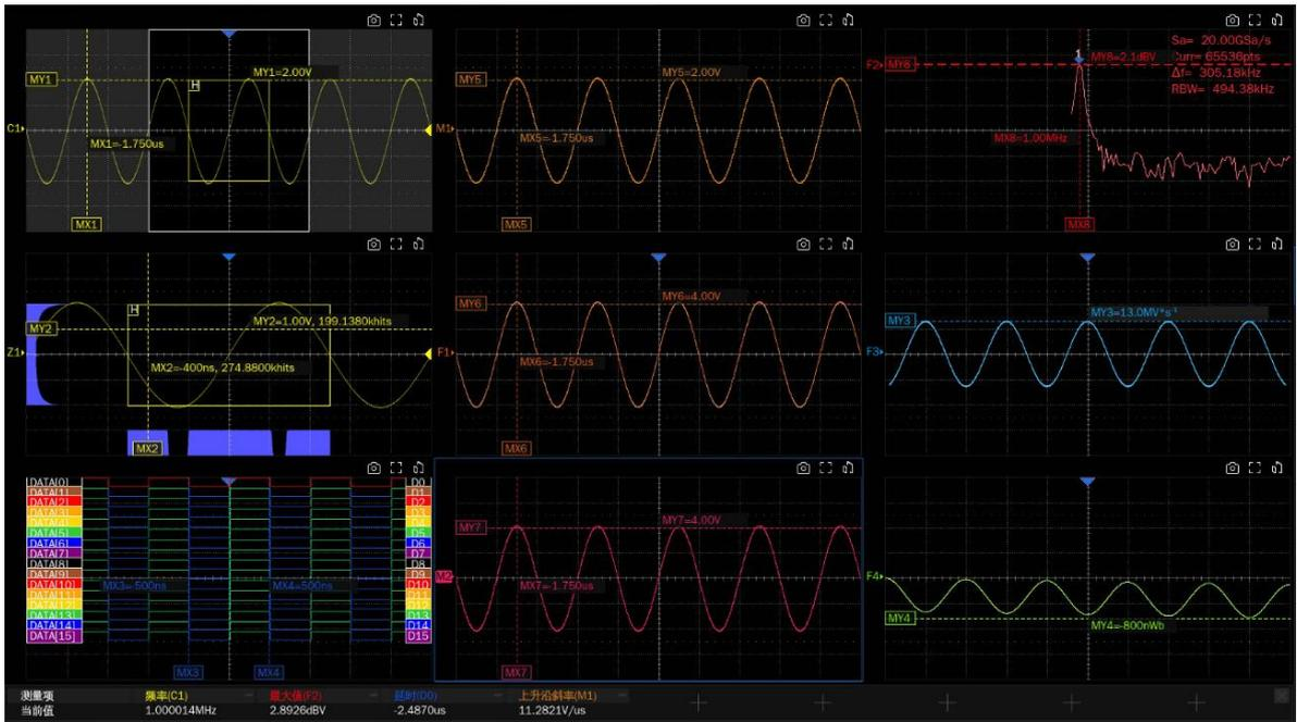
**追踪** -- 1 组追踪光标包含 2 根光标线：TX 和 TY，只需要调节水平光标 TX，垂直光标 TY 将自动附着到与水平光标交汇的信源波形上。此模式有 8 组光标 TX1~TX8
