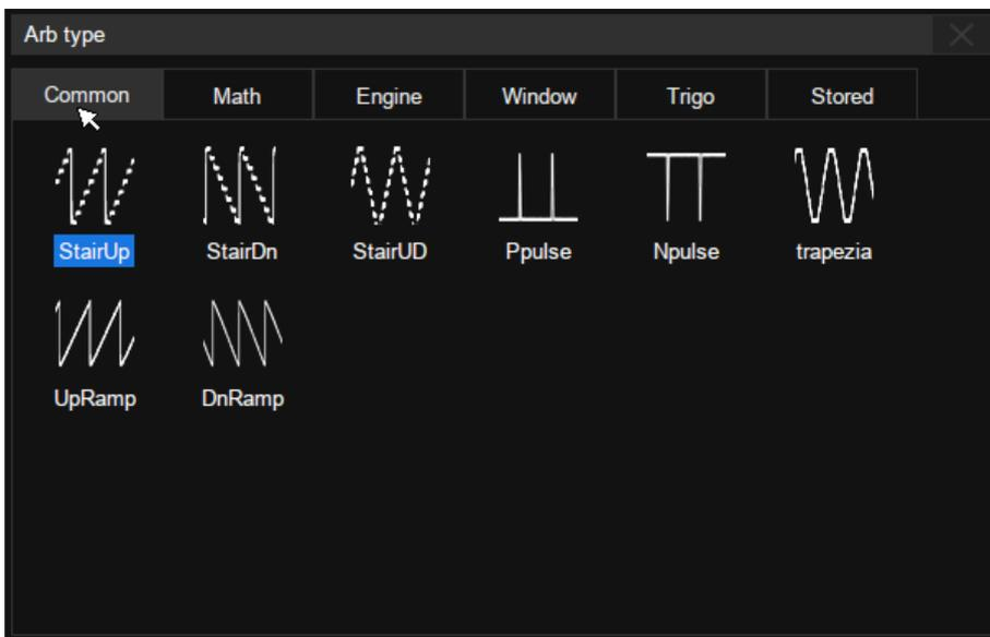
窗口中共有 6 个标签页，点击不同的标签可选择不同分类的任意波。其中 Common、Math、Engine、Window 和 Trigo 中存储的是内建波形，Stored 中存储的是已存波形。
