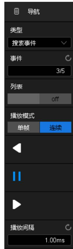
点击 **列表** 区域开启或关闭列表。列表中包含了每个事件的时间标签。点击列表中的一行可自动跳转到该行对应的事件，效果等同于在 **事件** 区域指定事件。
