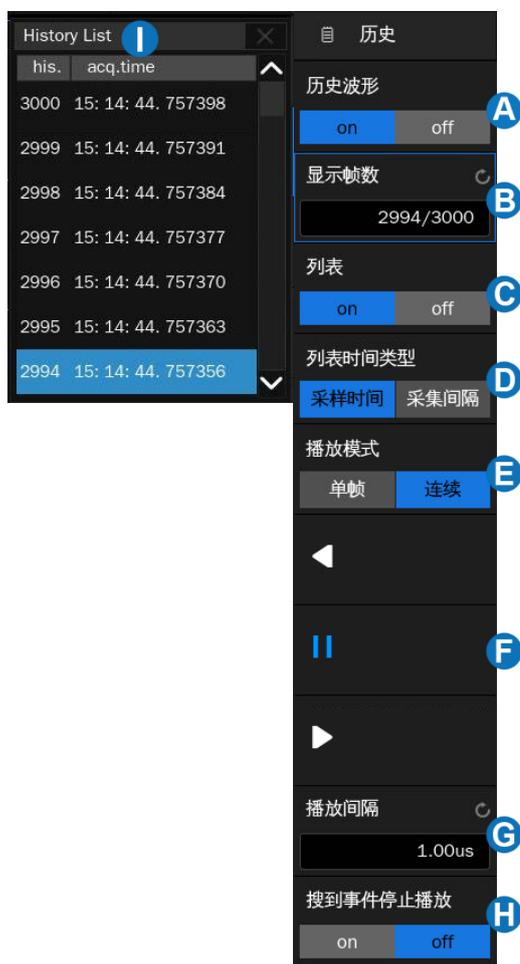
当您开始使用示波器时，示波器将自动采集并存储数据，可采集的帧数随当前时基下的采样点数不同而不同，最大支持到 124,000。打开历史模式可以观察之前存储的波形，并对其进行测量分析和数学运算。您可以通过波形导航以不同的速度来捕捉个别细节或随时间变化的波形。
