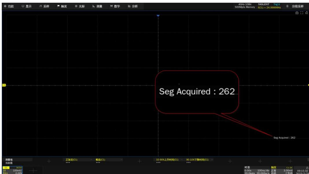
Sequence 模式，指定的段数未采集满前不显示波形，此时屏幕上有计数器指示已采集完成的段数
