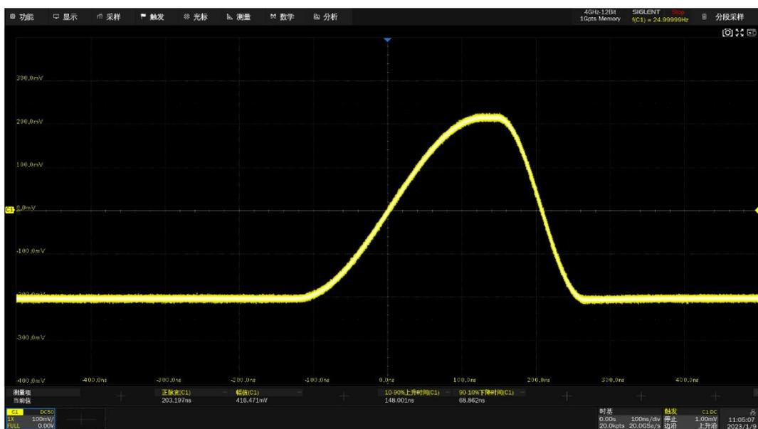
Sequence 模式，能以 20 GSa/s 的采样精度获得 43231 个脉冲
