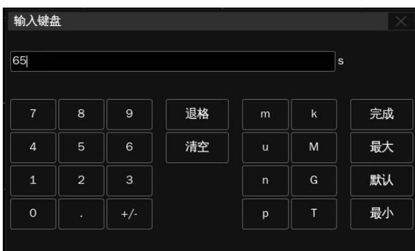
以通道时滞为例，若需要指定为 65 ns，输入“65”，并点击数字键盘上的 **n** 按钮完成设置。在数字键盘上，可以选择 **Max**、**Min** 快速设置为参数的最大值和最小值，或选择 **Default** 设置为参数的默认值。
