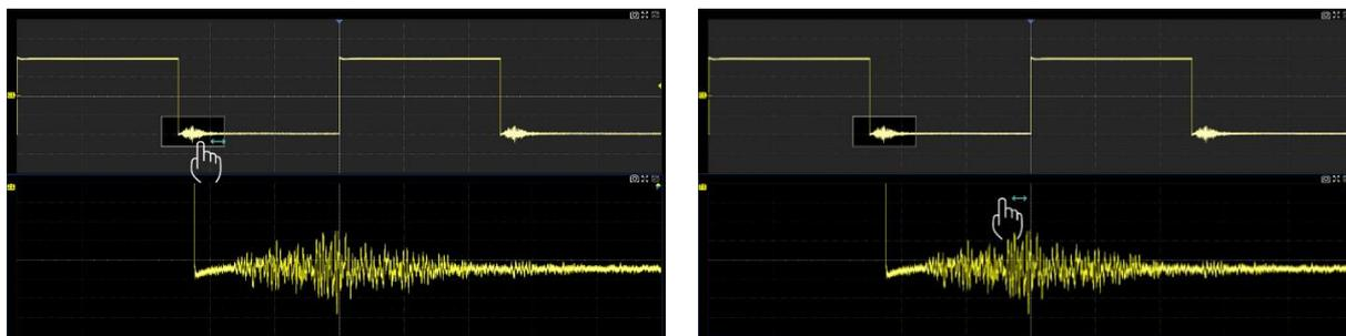
在主窗口的放大区域或 Zoom 窗口左右拖动鼠标来控制放大区域的水平位移；上下拖动鼠标来控制放大区域的垂直位移
