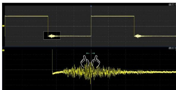
在主窗口的放大区域或 Zoom 窗口通过水平方向的两点缩放手势控制 Zoom 窗口的水平档位；通过垂直方向的两点缩放手势控制 Zoom 窗口的垂直档位
