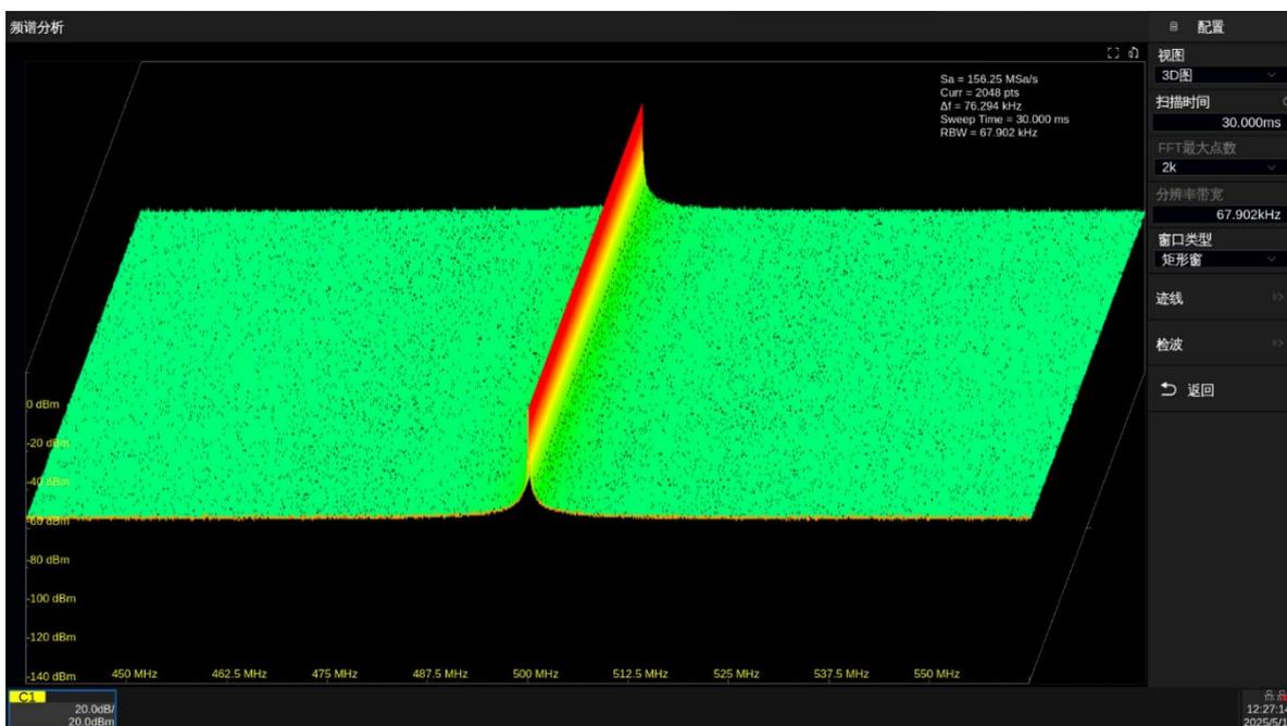
3D 图可以简单理解为频谱图和频谱监测的结合，是按时间顺序将多帧频谱滚动显示在屏幕上。每一帧检波结果绘制成一个 XY 平面上带色温效果的频谱波形，随时间推移，多帧频谱波形在 Z 轴方向上滚动显示。
