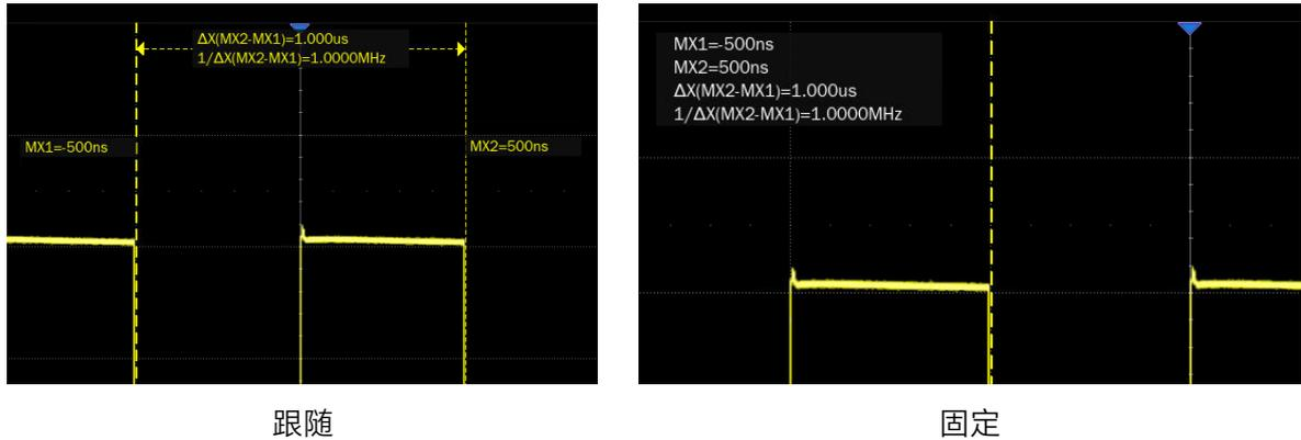
**跟随** -- 每根光标的位置信息直接标注在光标上，若两根光标建立了参考关系且在同一窗口，则会标注差值信息位于两根光标之间，并用箭头与光标连接。该模式较为直观。
