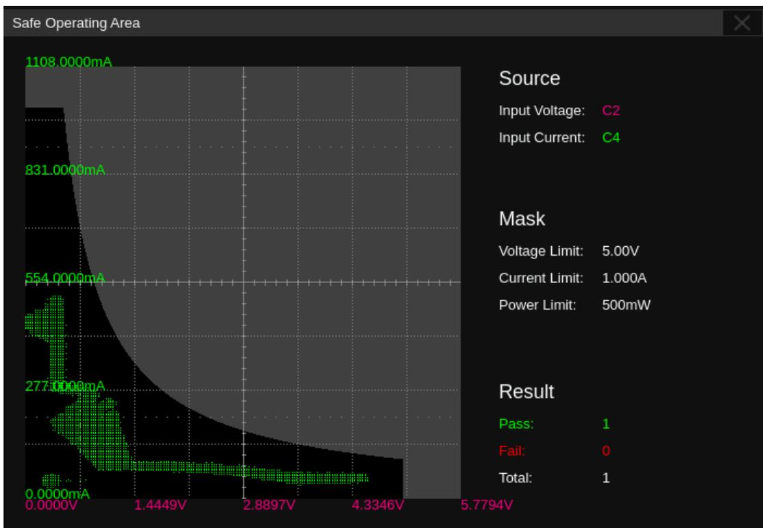
SOA，其中根据电压限制、电流限制和功率限制创建模板。结果显示“通过”，因为所有应力都在模板内。
