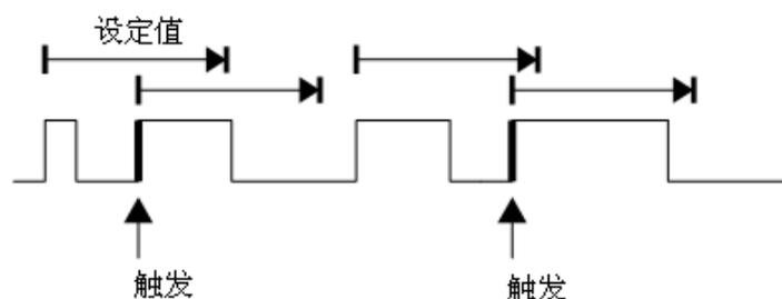
可以在触发设置对话框中设置触发源和斜率（上升沿、下降沿）、限制条件和时间。在间隔触发中也可设置触发释抑、耦合以及噪声抑制，具体设置方法，请分别参见“触发释抑 (Holdoff)”、“触发耦合”和“噪声抑制”章节。
