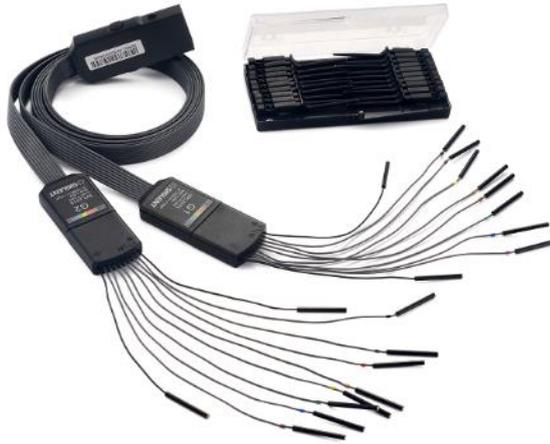
两组信号在逻辑分析仪探头中可独立设置阈值电平，这样用户可以使用同一个探头同时观察两种不同的数字逻辑电平信号。
