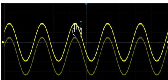
通过单点上下移动控制波形的垂直位移。当多个通道打开时，控制的是当前激活的通道
