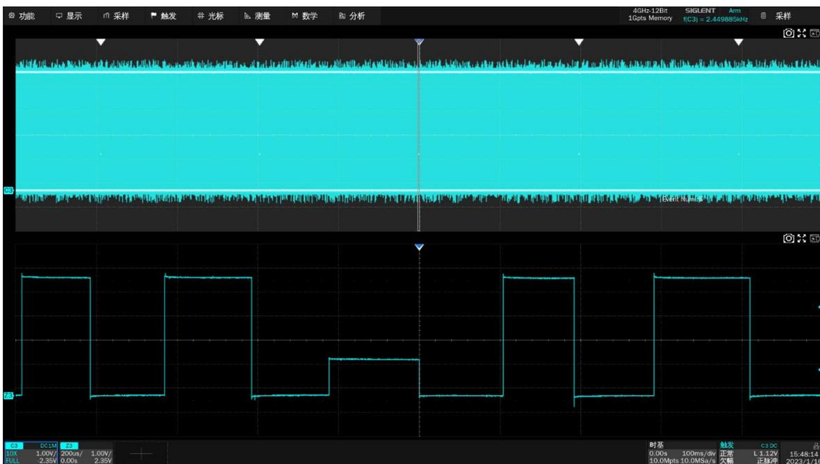
执行 **采样** > **运行/停止** 来停止采集，并执行 **分析** > **导航** > **类型** 选择“搜索事件”，即可快速浏览每一个矮脉冲。下图为正在浏览第一个矮脉冲。注意屏幕上的列表中还标注了每次事件的时间标签。
