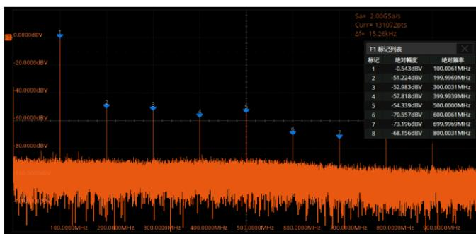
通过硬件加速的 FFT 功能，最大运算点数为 2M 点，在提供优越的频谱分辨率的同时，仍然能保持较高的频谱刷新率。支持多种窗函数，支持普通、平均、最大值保持等模式，支持自动标记峰值点
