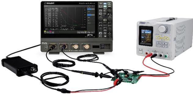
利用波特图测试系统的频率响应或环路稳定性，在一定领域取代昂贵的网络分析仪。可搭配波形发生器选件或 SDG 系列任意波形发生器
