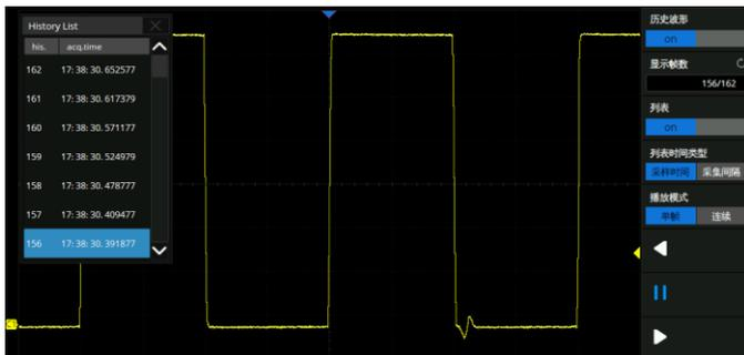
最大可记录 80 000 帧波形；自动实时录制，随时可回放历史波形观察异常事件，并通过光标或测量参数快速定位问题来源；可录制模板测试的失败帧
