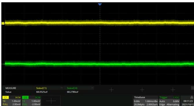
优秀的本底噪声性能，在 500 MHz 全带宽下的底噪值仅为 70  $\mu$ Vrms，让 12-bit ADC 充分发挥性能
