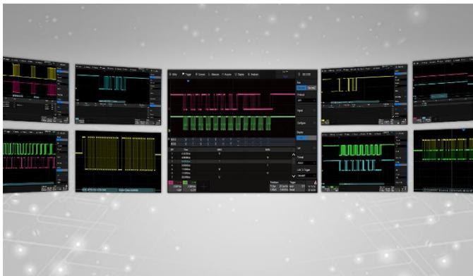
通过事件列表显示解码, 能快速、直观地将总线的协议信息以表格形式显示。支持 I<sup>2</sup>C、SPI、UART、CAN、LIN、CAN FD、FlexRay、I<sup>2</sup>S、MIL-STD-1553B、SENT、Manchester 和 ARINC429 等多种协议
