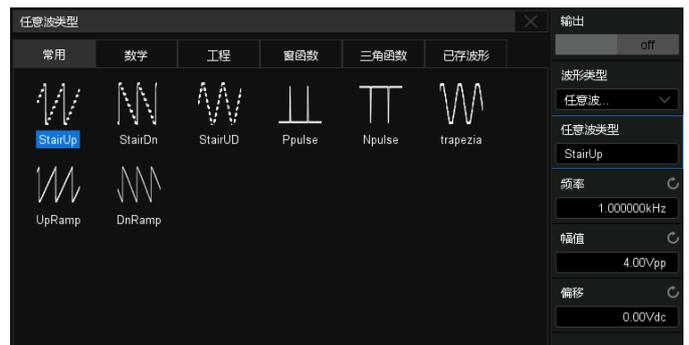
内置 25 MHz 函数/任意波形发生器功能，集成了几十种常用内置波形，也可通过从外部导入波形。用户可直接将示波器捕获的波形通过波形发生器还原
