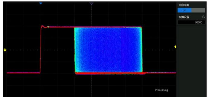
分段采集将波形存储空间分成多段，每段空间存储一个触发帧，最大可以采集 80 000 个触发事件，在 Sequence 周期内可最大限度地降低触发事件之间的间隔时间（小至 2  $\mu$ s），提高对异常事件的捕获概率。Sequence 模式下采集的所有波形段可以一次性全部映射到屏幕上，也可以通过 History 进行单帧回放
