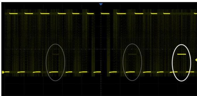
正常模式下 100 000 帧/秒，Sequence 模式下 500 000 帧/秒的波形刷新率，使示波器能轻松捕获到低概率异常事件
