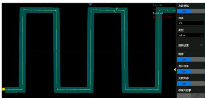
基于硬件的模板测试功能, 最高每秒可执行 14 000 次测试。根据用户自定义的垂直和水平容限生成模板, 比较被测信号是否触碰模板, 如果被测信号触碰模板则测试失败, 可以预先设定测试失败时采集停止以及蜂鸣器告警, 将失败帧自动截图或存入历史帧, 适用于长期无人值守监测异常信号
