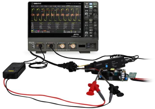
电源分析选件能帮助用户快捷测量和分析电力电子领域中的多个项目，如电源质量，谐波，浪涌电流，开关损耗，输出纹波，瞬态响应，电源抑制比，功率效率等
