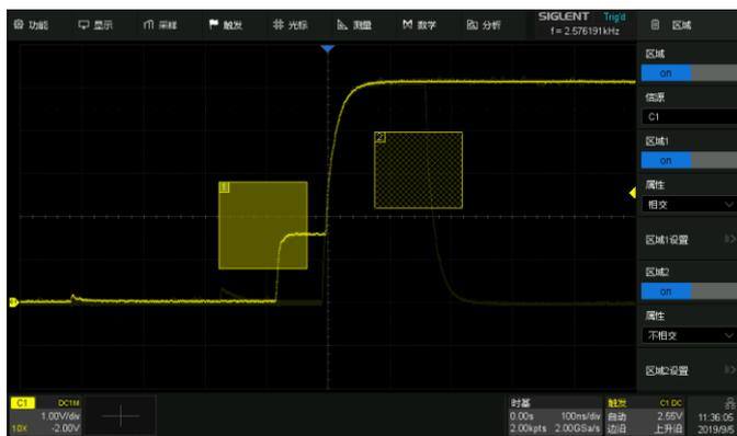
区域触发可以简化高级触发的操作，快速隔离出感兴趣的波形
