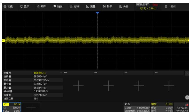
优秀的本底噪声性能，在200 MHz全带宽下的底噪仅为 $70 \mu\text{VRms}$ ，让12-bit ADC充分发挥性能
