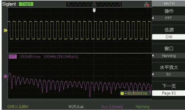
SDS1000A/SDS1000CNL+/SDS1000DL+ 系列产品提供 5 种常用的波形运算: +、-、\*、/、FFT, 支持通道波形和 FFT 波形分屏显示, 方便用户同时观测
