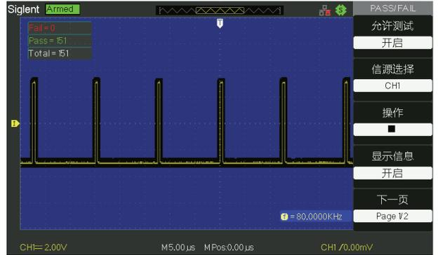
Pass/Fail 功能可根据用户自定义的垂直和水平容限, 将被测信号与创建的模板信号进行比较, 适用于长期监测信号或进行生产线测试
