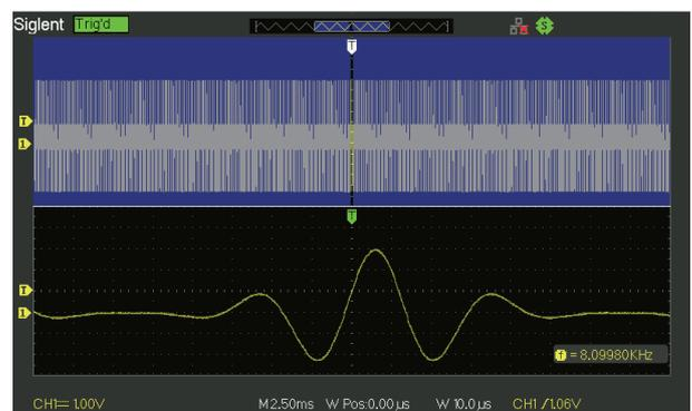
一键式设计的视窗扩展功能可对整体波形的局部做波形扩展显示, 极大方便了用户对波形的观察、测量和分析
