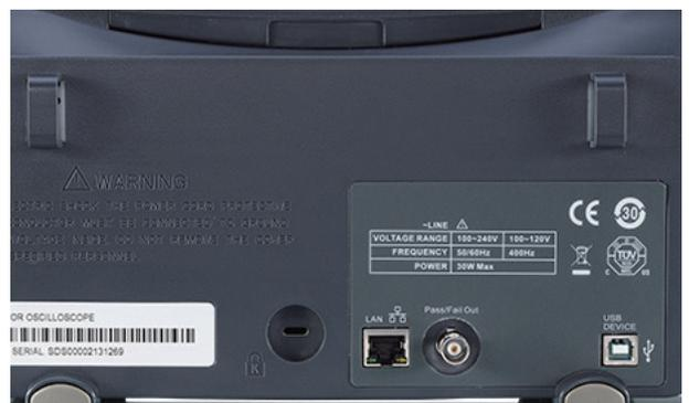
SDS1000A/SDS1000CNL+/SDS1000DL+ 支持 USB Host、USB Device(USBTMC)、LAN (VXI-11)、Pass/Fail 接口
