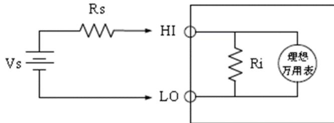
图 8-1 负载误差来源示意图 (DC 电压)
