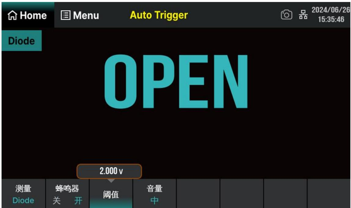
图 7-5 设置导通电压
