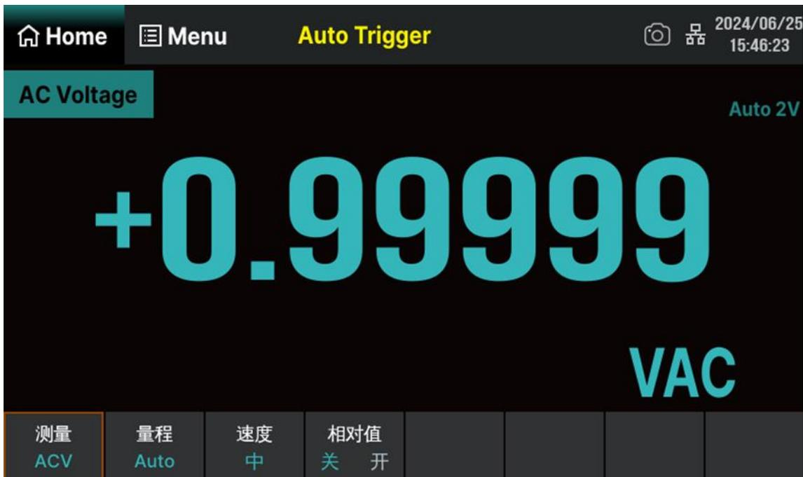
图 7-8 交流电压测量界面
