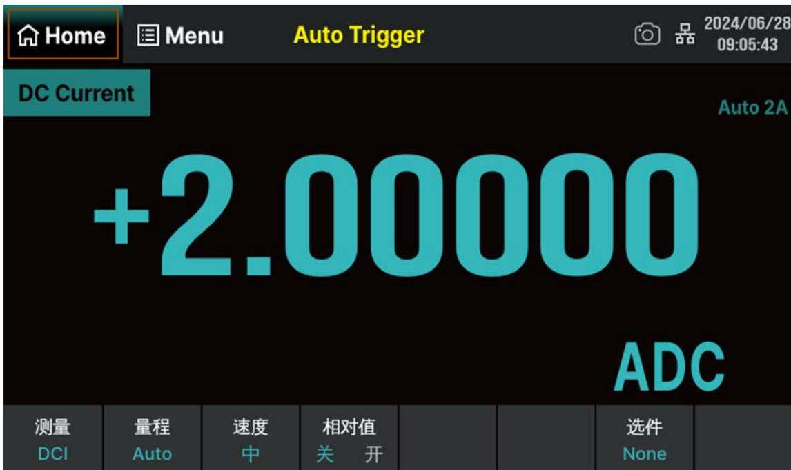
图 7-9 直流电流测量界面
