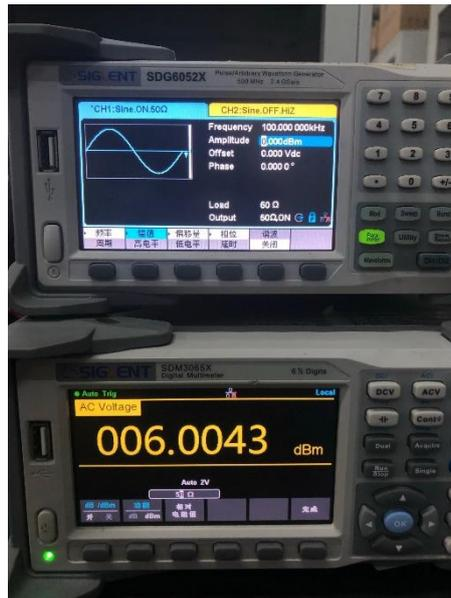
图 2-66 dBm 测量显示界面
