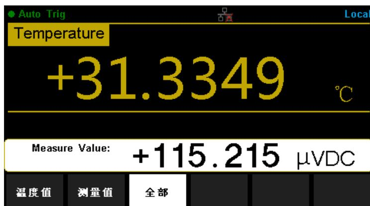
图 2-23 温度测量显示模式选择界面
