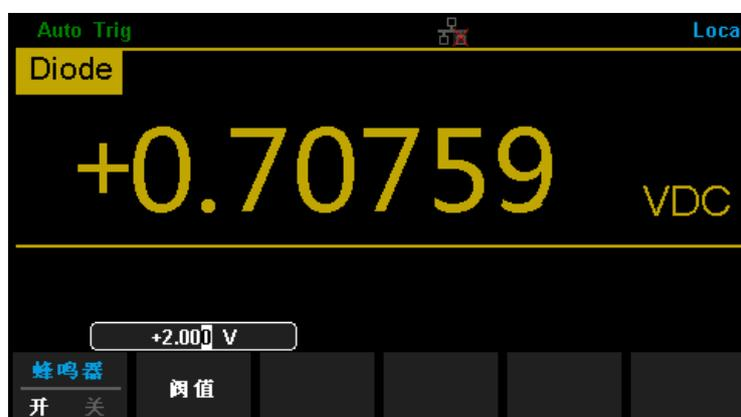
图 2-8 设置导通电压
