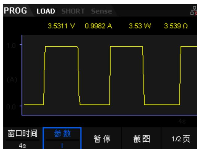
图 2-44 Program 自动测试功能波形显示界面
