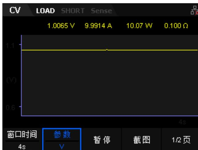
图 2-7 CV 模式波形显示界面
