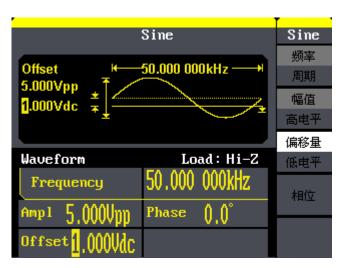
图 3-1 输出正弦波形
