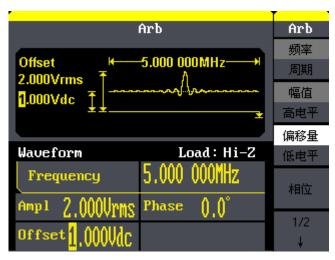
图 3-6 输出存储的任意波形
