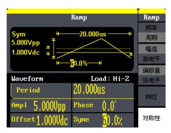
图 3-3 输出三角波/锯齿波形
