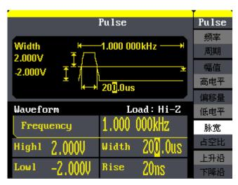
图 2-10 脉冲波参数显示界面
