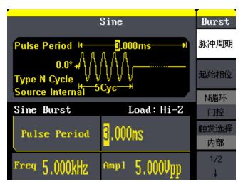
图 3-8 输出脉冲串波形
