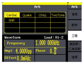
图 2-18 工程函数内建波形显示界面
