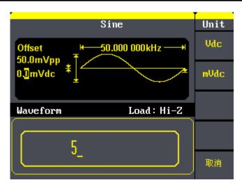
图 2-4 正弦波偏移量设置界面
