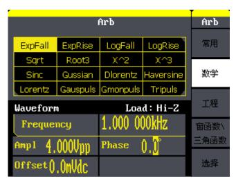
图 2-17 数学函数内建波形显示界面
