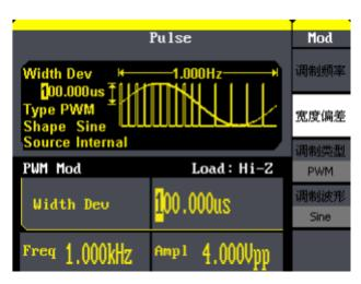
图 3-15 输出 PWM 调制波形
