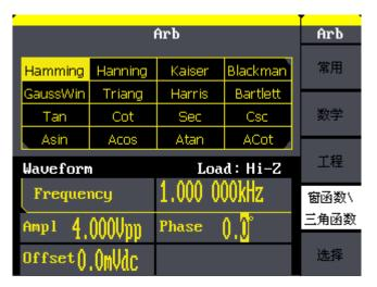
图 2-19 窗函数\三角函数内建波形显示界面
