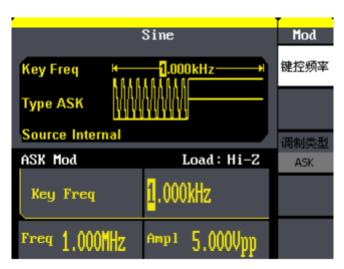
图 3-14 输出 ASK 调制波形
