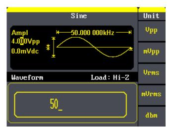
图 2-3 正弦波幅值设置界面
