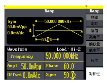
图 2-8 锯齿波/三角波参数显示界面
