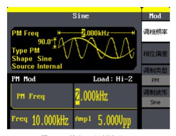
图 3-12 输出 PM 调制波形
