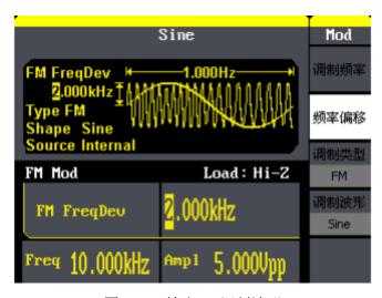
图 3-11 输出 FM 调制波形
