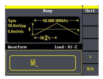
图 2-9 锯齿波/三角波对称性设置界面
