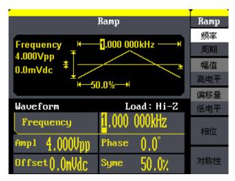
图 1-8 锯齿波/三角波参数设置界面
