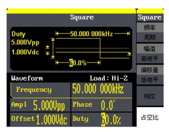
图 3-2 输出方波波形
