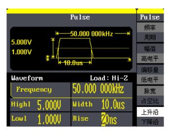
图 3-4 输出脉冲波形
