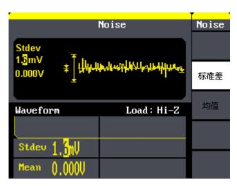
图 2-13 噪声参数显示界面
