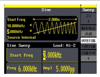
图 3-7 输出线性扫描波形
