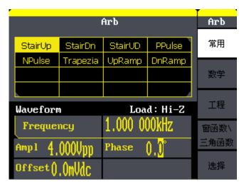
图 2-16 常用函数内建波形显示界面
