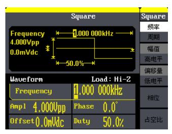
图 2-6 方波参数显示界面
