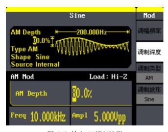
图 3-9 输出 AM 调制波形
