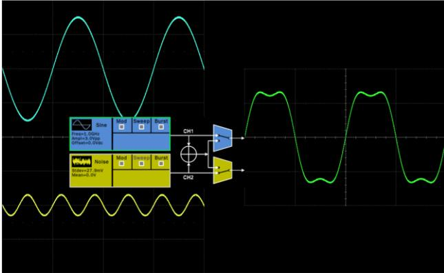
**双通道合并** 能够将两通道波形合并后输出，具备实时性好、可叠加真正的噪声、可叠加调制信号、扫频信号、Burst 信号、EasyPulse 波形和 TrueArb 波形的优点，为用户提供了精确生成复杂波形的新技术。
