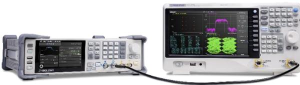
可生成常用的 ASK, FSK, PSK, QAM 等调制类型的 IQ 信号。采用创新的重采样技术, 可以在 250 Symb/s ~ 500 MSymb/s 范围内的任意符号率下获得优异的 EVM 性能。内建的数字正交调制器可将 IQ 信号的载波调制到 1 GHz 范围内的任意频点; 可使用上位机软件 EasyIQ 来生成各种类型的 IQ 信号。
