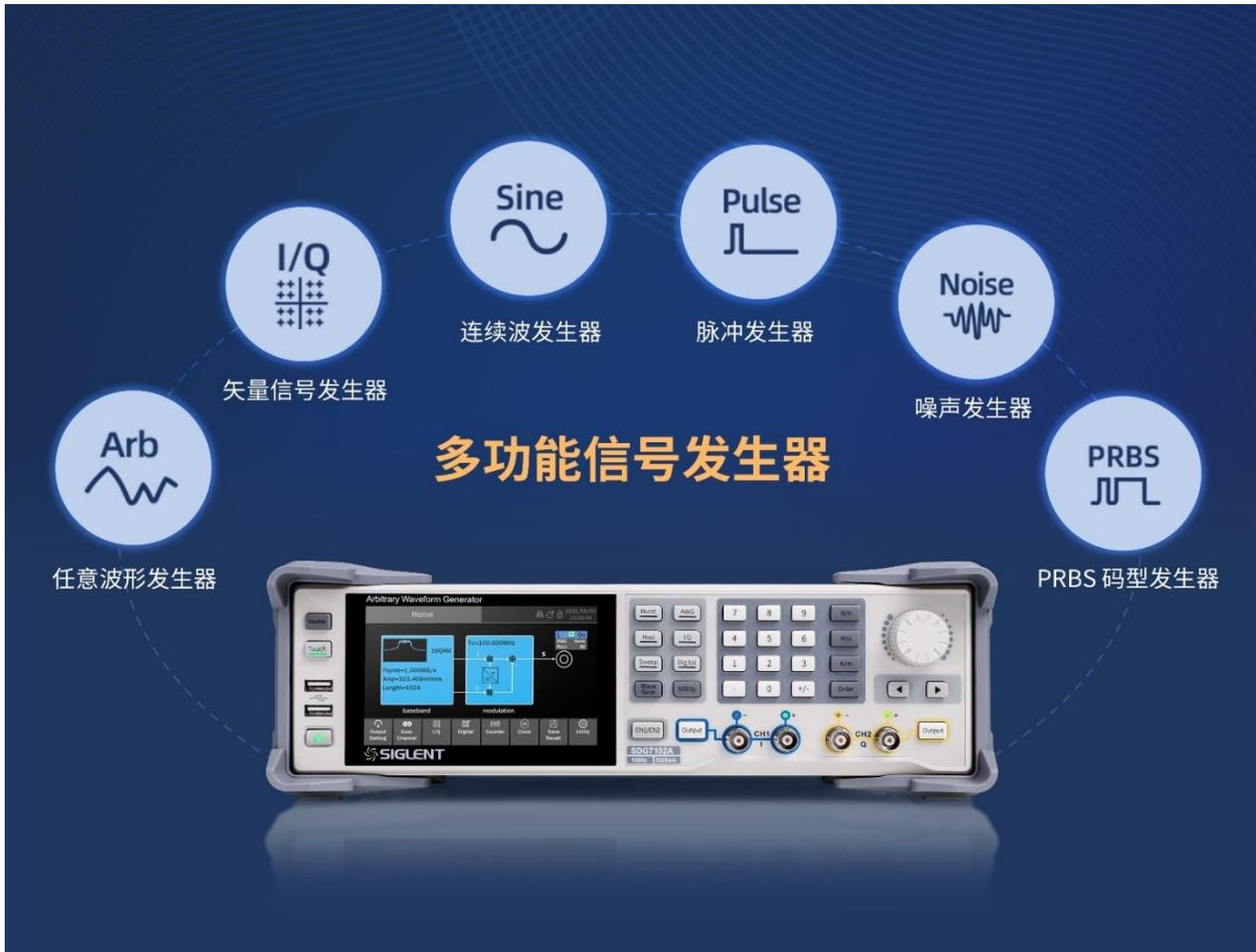
SDG7000A 是一款集多种信号发生器功能于一体的产品。它可以产生直流到 1 GHz 范围的连续波，在一定场合下取代射频信号源；采用了鼎阳的 TrueArb 逐点任意波形发生技术，可以在 0.01 Sa/s ~ 2.5 GSa/s 的范围里任意设置采样率，输出低抖动的任意波；可以产生 I/Q 矢量信号，最大可设置的带宽超过 500 MHz；基于 EasyPulse 脉冲发生技术，可以产生脉宽最小只有 1 ns 的低抖动脉冲；可以产生带宽可调的高斯噪声；可以产生伪随机码；另外提供 16 路数字信号输出。
