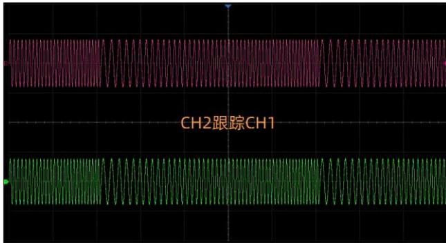
**跟踪/复制/耦合** 两个通道间的跟踪、复制和耦合能力，确保一个通道的参数根据需求快速传递到另一个通道，大大简化操作，并满足快速、同步切换波形的需求。
