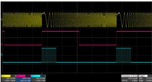
**扫频和脉冲串** 扫频有“频率扫描”、“幅度扫描”和“频率&幅度”三种扫描类型，支持“线性”、“对数”和“步进”三种扫描方式，脉冲串支持“N 循环”和“门控”两种 Burst 方式。扫频和脉冲串都支持“内部”、“外部”和“手动”3 种触发源。
