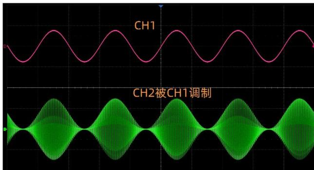
**互为调制源** 两个通道可互为调制源，为提供复杂的调制波提供了新的手段。作为调制波的通道可同时输出，直接与解调信号进行对比。
