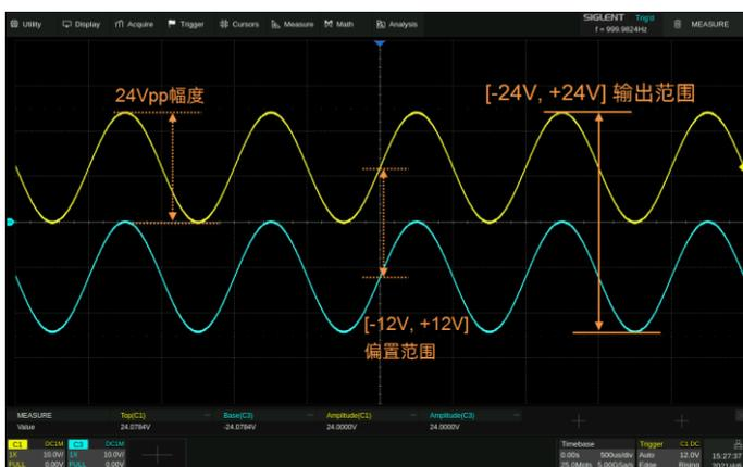
24 Vpp 模拟输出能力叠加  $\pm 12$  V 直流偏置，最大可提供  $\pm 24$  V (48 V) 的输出范围。
