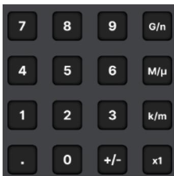
使用数字键盘直接输入选中参数的数值和数量级。例如设置频率为 1 MHz, 依次按按键 **1** 和 **M/μ** 即可。
