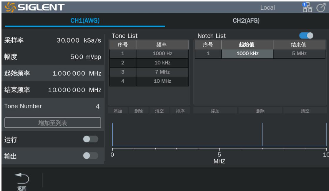
如在 Notch List 中设置一个频率范围,起始值为 1 MHz,结束值为 5 MHz,开启 Notch Switch, 点击 **增加至列表** 后,会将 Tone List 中落在 [1 MHz, 5 MHz] 范围内的 1 MHz 和 4 MHz 清除,只剩下 7 MHz 和 10 MHz 两个频点。
