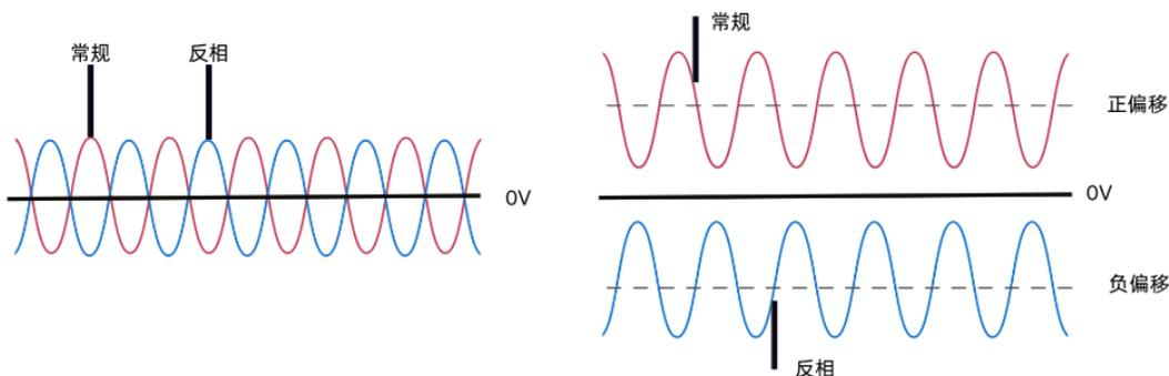
备注：在波形反相时，与波形相关的同步信号并不反相。
