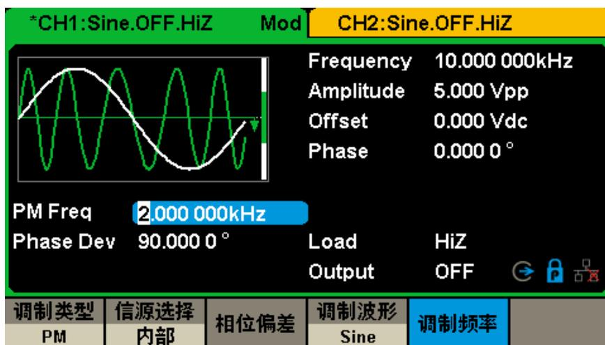
图 3-11 输出 PM 调制波形
