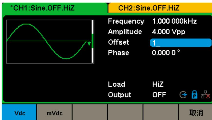
图 2-4 正弦波偏移量设置界面
