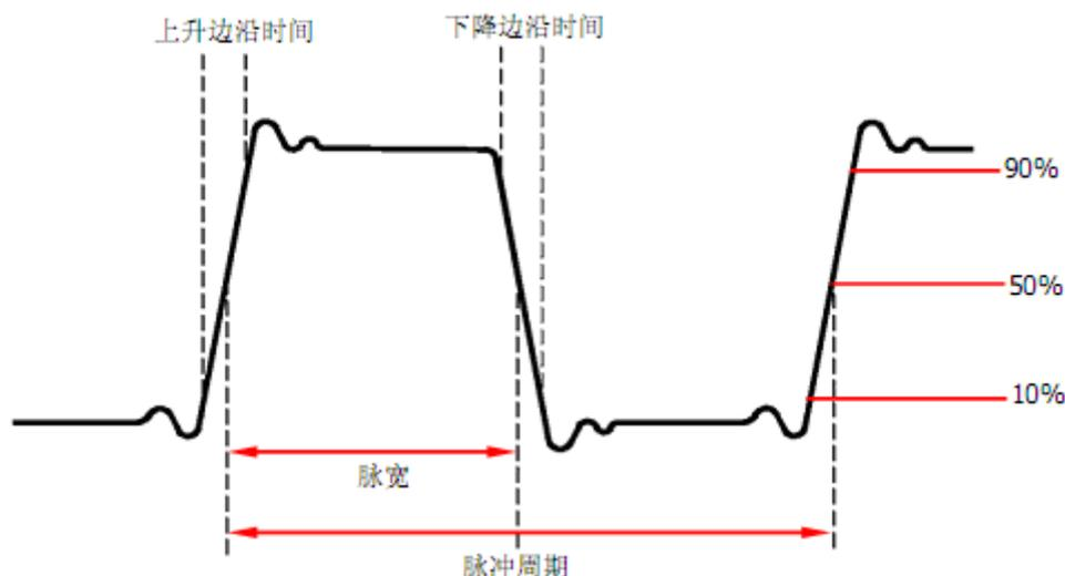
选择 **Waveforms** → **Pulse** → **脉冲宽度**，可设置脉冲宽度数值。在更改参数时，如果当前的参数值对新波形是有效的，则使用当前值，否则使用该波形的限定值。
