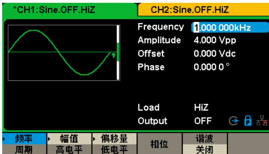
图 2-1 正弦波参数显示界面
