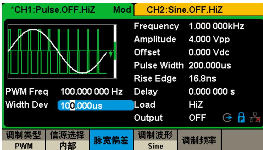
图 3-15 输出 PWM 调制波形
