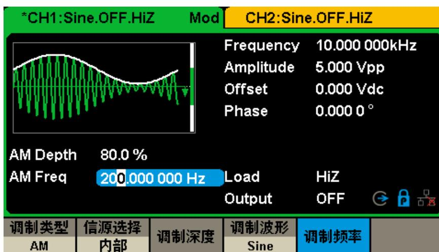
图 3-8 输出 AM 调制波形
