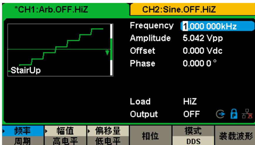
图 2-17 任意波 DDS 模式参数显示界面
