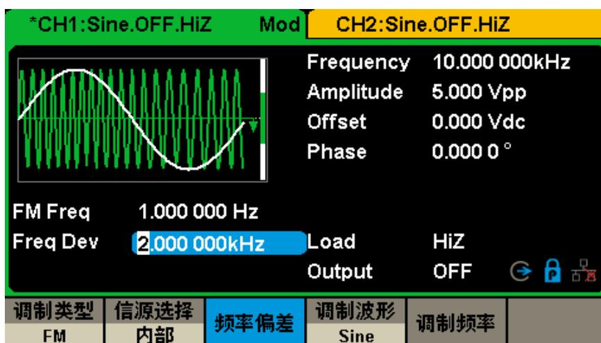
图 3-10 输出 FM 调制波形
