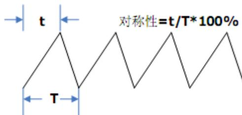
选择 **Waveforms** → **Ramp** → **对称性**，可设置对称性百分比数值。屏幕中显示的对称性百分比数值为本机的默认值，或者是上次设置值。在更改参数时，如果当前的参数值对新波形是有效的，则使用当前值，否则使用该波形的限制值。
