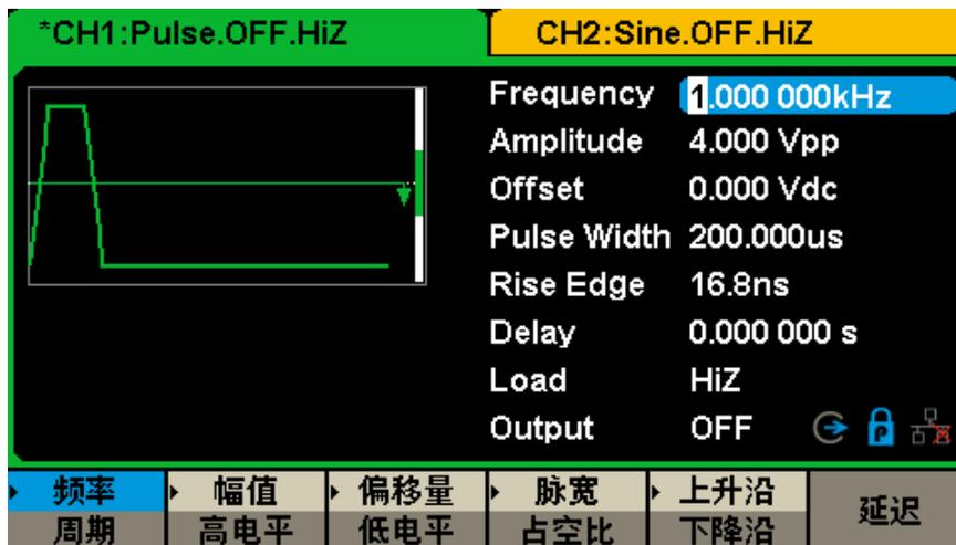
图 2-10 脉冲波参数显示界面
