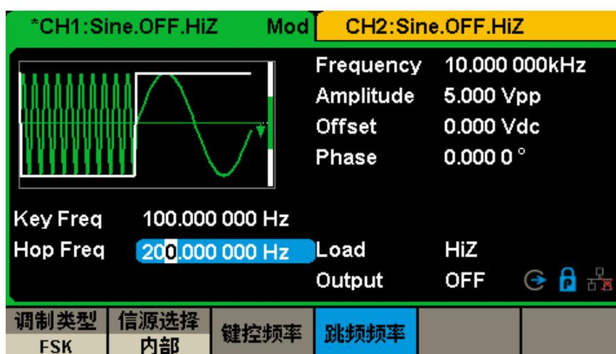
图 3-12 输出 FSK 调制波形
