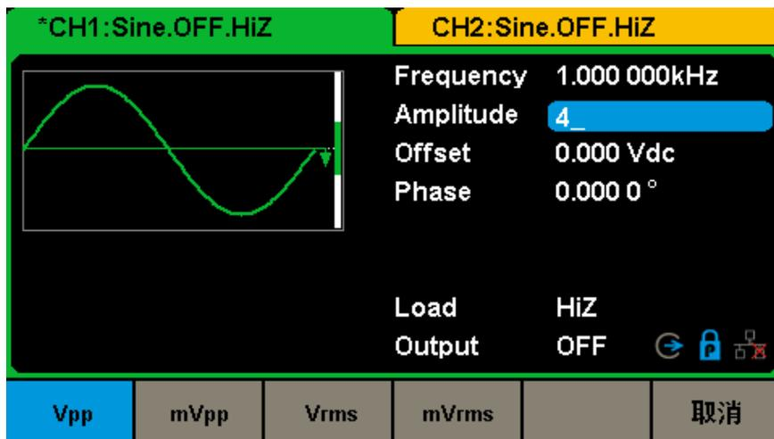
图 2-3 正弦波幅值设置界面
