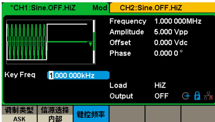
图 3-13 输出 ASK 调制波形
