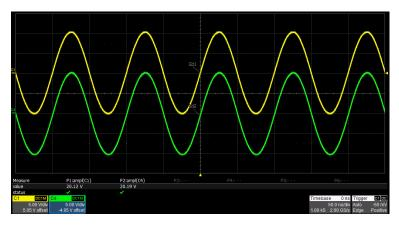
高频下的大幅度输出能力: 在 10 MHz 频率下仍然能保证双通道 20 Vpp 满幅度输出。
