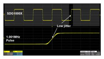
DDS方法输出脉冲时,如果采样率和输出频率不成整数倍关系,将产生一个采样周期的抖动。SDG1000X采用的 EasyPulse 技术,能够克服DDS的这个缺陷,产生低抖动的脉冲信号。
