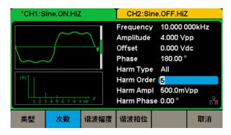
最高可产生 16 次谐波,每次谐波的幅度和相位可分别设置。
