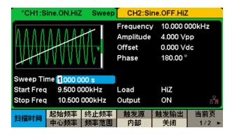
支持"线性"和"对数"两种扫频方式,"向上"和"向下"两个扫频方向,"内部"、"外部"和"手动"3种触发源。
