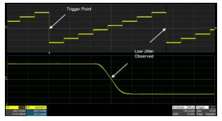
同 EasyPulse 一样,TrueArb 技术有效克服了DDS产生一个采样周期抖动的缺陷,能产生低抖动的任意波。
