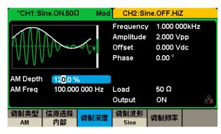
支持 AM、FM、PM、FSK、ASK、PSK 和 DSM-AM、PWM 等多种模拟和数字调制方式,"内部"和"外部"两种调制信号源。
