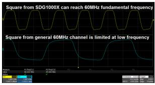
得益于专门的方波产生电路, SDG1000X 产生的方波打破了 60 MHz 的通道带宽限制, 其输出频率可达 60 MHz, 上升/下降沿低于 4.2 ns。
