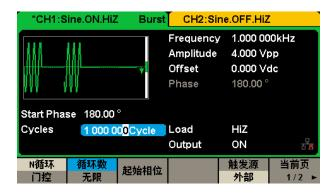
支持 "N 循环"和 "门控"两种 Burst 方式, "内部"、 "外部"和 "手动"3 种触发源。
