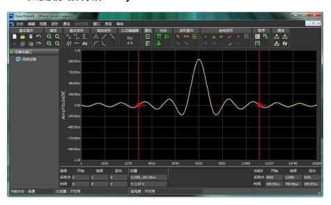
EasyWaveX 提供功能强大的任意波编辑功能,支持手动、直线、坐标、方程式绘图等多种绘图方式,可方便、快捷地生成任意波形。
