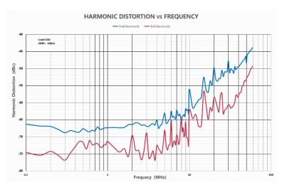
0 dBm 输出幅度下的THD (总谐波失真) 指标小于 0.15%; 全频段内的谐波和杂散均小于 - 40 dBc。
