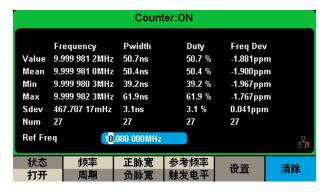
高精度频率计,可测试 0.1 Hz~200 MHz 的频率范围。
