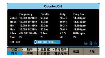
高精度频率计,可测试 0.1Hz~200MHz 的频率范围
