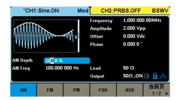
丰富的调制功能,支持常用的AM/DSB-AM/FM/PM/ASK/FSK/PSK/PWM调制方式
