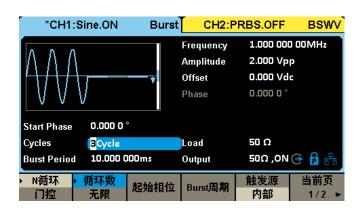
支持 "N 循环"和 "门控"两种 Burst 方式可选 "内部"、"外部"和 "手动"三种触发源
