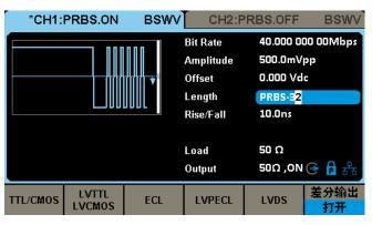
可快捷选取预设的电平逻辑如 TTL、LVCMOS、LVPECL 和 LVDS。差分模式可轻松将两通道设置成差分对输出。
