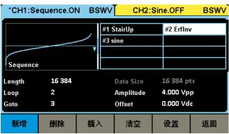
轻松设置各段波形循环次数,以及波形播放顺序 连续、burst、单次三种运行模式 可选"内部"、"外部"、"手动"三种触发源
