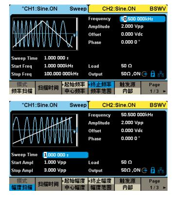
支持频率和幅度两种Sweep模式,轻松实现扫频、扫幅 测试
