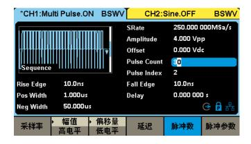
支持最大设置30个脉冲,每个脉冲可独立设置脉冲沿和 正负脉宽
