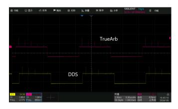
TrueArb 在输出任意波时,不仅具备传统 DDS 技术的所有优点,而且克服了其可能增加抖动和失真的严重缺陷,因为 TrueArb 技术会逐点输出存储器中任意波形的每一个波形数据点,不会遗漏任何细节,可精确地生成低抖动的任意波形。
