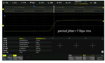
DDS 方法输出方波 / 脉冲时,如果采样率和输出频率不成整数倍关系,将产生一个采样周期的抖动。SDG1000X Plus 采用的 EasyPulse 技术,能够克服DDS的这个缺陷,产生低抖动的方波 / 脉冲信号。
