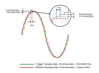
16-bit, 1 GSa/s 的采样系统,在时间和幅度上都具备极高的分辨率,能最大限度地还原波形细节、避免失真
